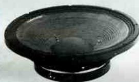
Boomer Ø 38 cm, série professionnelle, destiné à l'équipement d'enceintes à très haut rendement. Moteur ferrite Ø 220 mm et bobine mobile spéciale de Ø 100 mm assurant une puissance admissible de 200 W.
