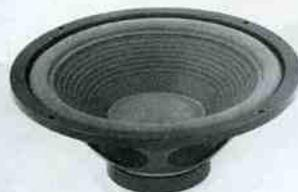
Une membrane légère et rigide associée à une bobine de 46 mm de diamètre et à un moteur puissant permettent à ce modèle de posséder une bonne réponse impulsionnelle et un rendement élevé.
