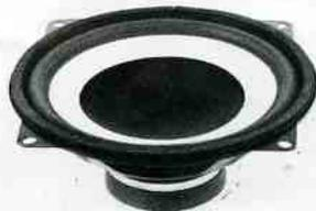
Ce Haut-parleur de grave médium est équipé d'une membrane à profil non développable suspendue par un bord mousse qui permet de grandes elongations sans distorsion.
