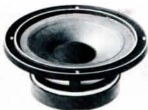
Haut-parleur de médium de très haute qualité, à haut rendement. Sa membrane à profil exponentiel, montée sur une suspension plane amortie, lui assure une coupure naturelle exempte de résonance.
