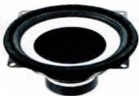
Ce Haut-parleur de grave médium est équipé d'une membrane à profil non développable suspendue par un bord mousse qui permet de grandes elongations sans distorsion.
