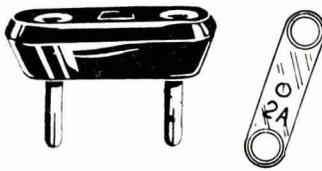
**Porte-Fusible**, bakélite moulée broches laiton nickelées. Fourni avec barette fusible amovible (fusion 2 A) écartement entre broches 20 <sup>m</sup>/<sub>m</sub> pour broches 3 <sup>m</sup>/<sub>m</sub> et 19 <sup>m</sup>/<sub>m</sub> pour broches de 4 <sup>m</sup>/<sub>m</sub> ..... 0,50
