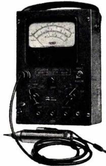
Appareil à impédance d'entrée élevée. Mesure des tensions BF - HF - VHF - THT. 1,5 à 150 V =, impédance d'entrée 7,5 MΩ. 1,5 à 1 500 V, impédance d'entrée 75 MΩ. 1,5 à 150 V ~; 50 Hz à 50 MHz. Sonde VHF 600 MHz sur demande. Dimensions 245 × 170 × 115 mm. PRIX ..... Net **500,00**
