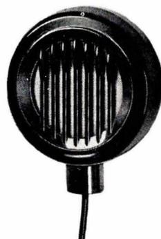
**KID** Ce modèle peut être fourni équipé d'une cellule 12 ou ZA (voir courbe ci-après). Sortie par fils avec embouts bananes. Se recommande par sa puissance et peut être branché directement sur la prise PU d'un poste. Microphone plus spécialement destiné pour la parole. Sensibilité dans des conditions normales d'emploi 3 mV. Impédance : 72 000 ohms à 1 000 ps.
