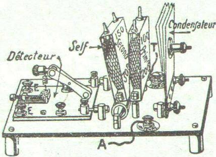
Vue de l'assemblage sur **SOCLE TESLA** ci-contre placé dans le **COFFRET SPÉCIAL**
