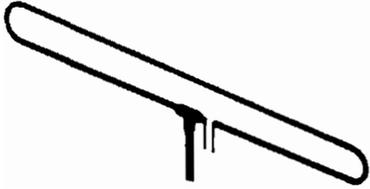
Antenne pliée d'une demi-longueur d'onde. Elle est sensible à tout signal perpendiculaire arrivant soit à l'avant, soit à l'arrière.
