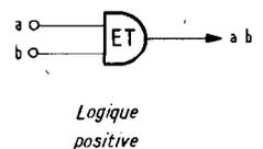
On dispose, par conséquent, pour constituer S, de  $a + b$  et de  $ab$ . Il faut transformer à l'aide d'un circuit de négation NON,  $ab$  en  $\bar{a}\bar{b}$ .
