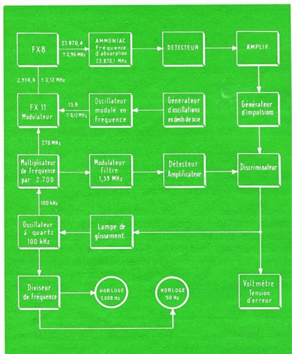
Fig. 2. Schéma d'une horloge utilisant la raie d'inversion de l'ammoniac.
