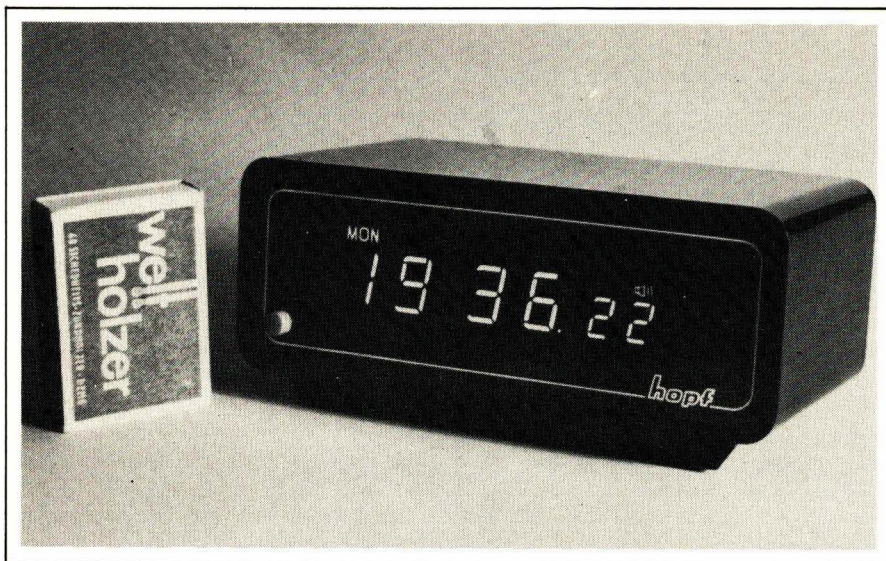
Fig. 1. — C'est bien ce boîtier (contenant récepteur, microprocesseur, affichage, alimentation et éventuellement antenne) qui est étonnamment petit, et non pas la boîte d'allumettes qui est plus grande que celles de la SEITA. L'affichage donne : heure, minutes, secondes ou, après manœuvre du bouton à gauche : jours du mois, mois, année. Le jour de la semaine (Mon = lundi) est toujours affiché. Photo Hops Elektronik KG.
