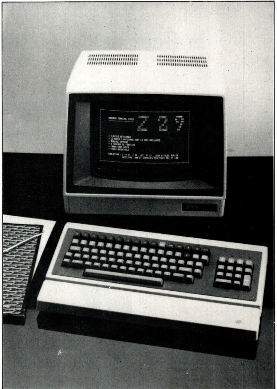
L'interface de communication est de type RS232C asynchrone à vitesse de transmission de 75 à 19 200 bauds.
