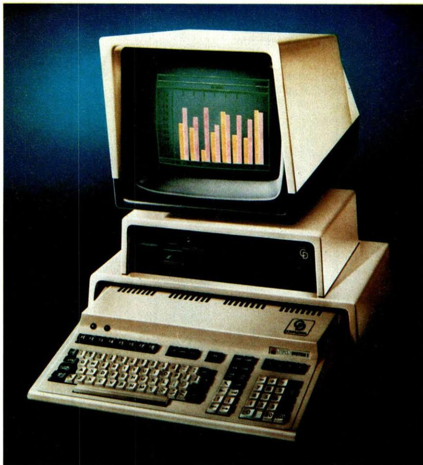
écran vert (phosphore P31), soit d'une version couleur de 12 pouces de diagonale avec possibilité d'afficher 80 x 25, ou 64 x 31, ou 40 x 25 (colonnes x lignes) caractères en utilisant une matrice 9 x 11 points.
