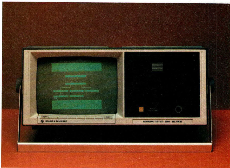
Le « SCUD » est à la fois un codeur-décodeur d'appels sélectifs de transmissions de données, un synthétiseur BF et un contrôleur de procédés IEC.
