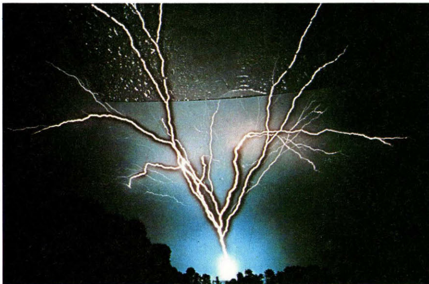
Fig. 10. — Coup de foudre déclenché. Photographie prise à 2,7 km de la station. Champ optique 5 \times 3,5 km (d'après RGE, sept. 1982, et l'aimable autorisation de C. Gary, Direction des études et recherches EdF).
