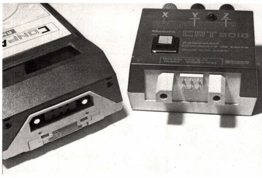
Photo 2. – Les différents adaptateurs se raccordent au multimètre par huit broches de connexion.
