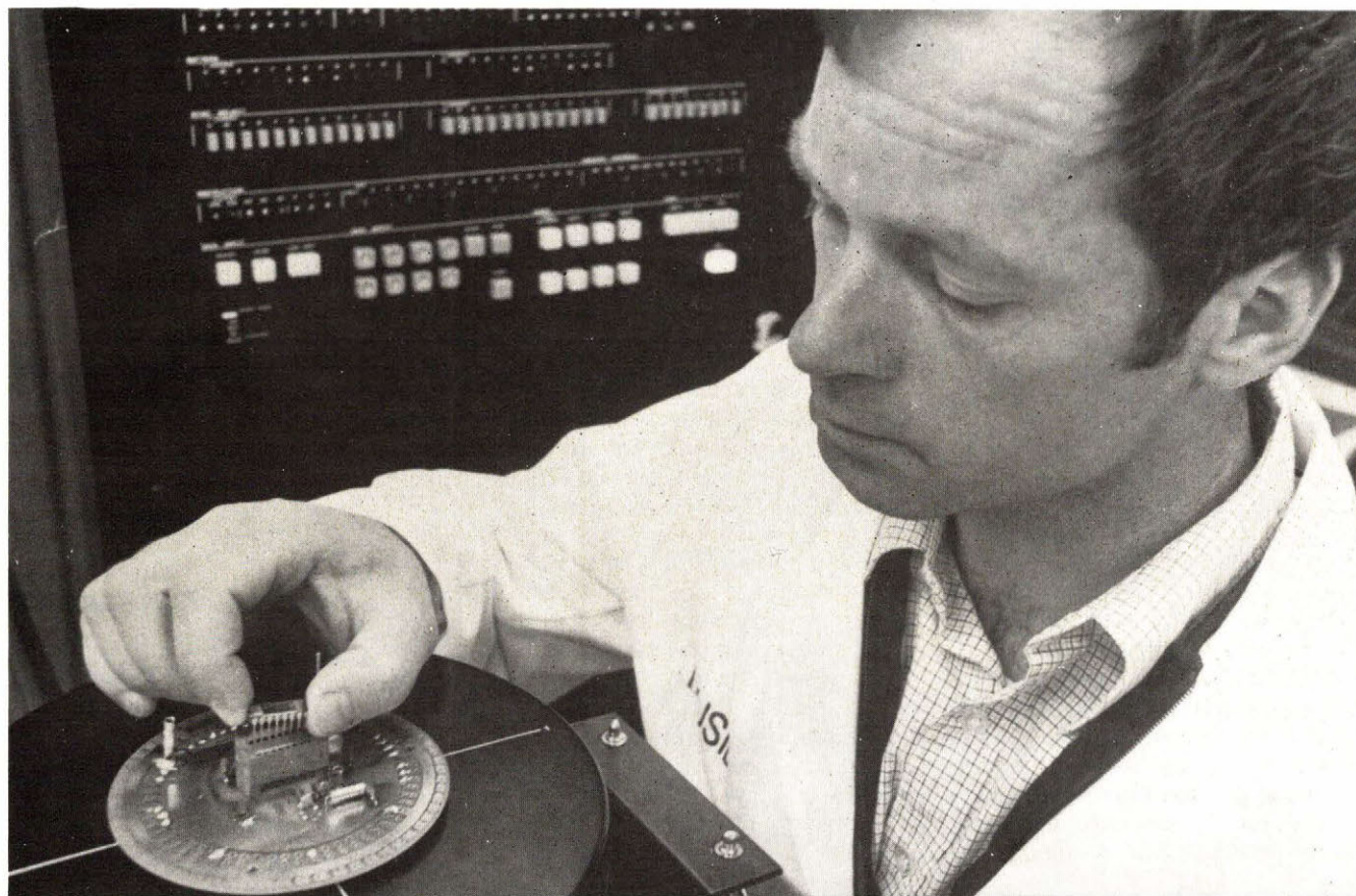
Photo B. – Le test des circuits intégrés complexes fait largement appel au calculateur. Au premier plan, l'embase où sont prélevés les paramètres de contrôle (doc. Siemens).
