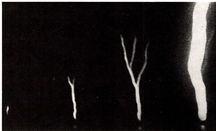
Fig. 24. — Phases de développement du streamer ascendant à la pointe du paratonnerre ionisant électrique Corona. La lecture se fait de gauche à droite. Le point lumineux situé en bas des clichés correspond au fonctionnement de l'éclateur du paratonnerre Corona (vitesse de prises de vues : 20 millions d'images par seconde — doc. Héliata).
