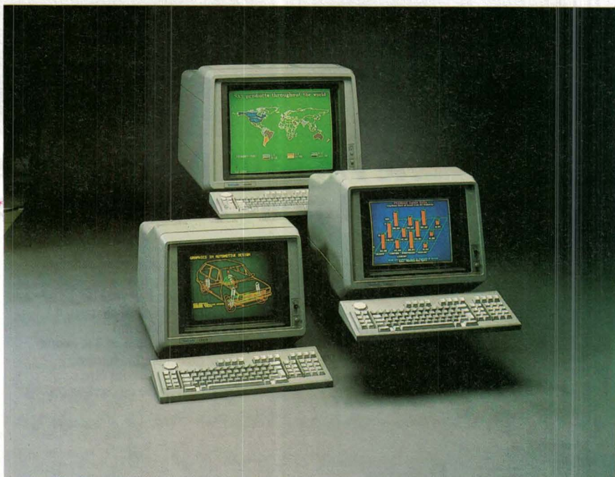
La nouvelle série CX 4100 de Tektronix permet aux utilisateurs IBM de bénéficier du jeu de commandes graphiques Plot 10 Tektronix tout en conservant le traitement alphanumérique des IBM 3270 et le clavier d'IBM.
