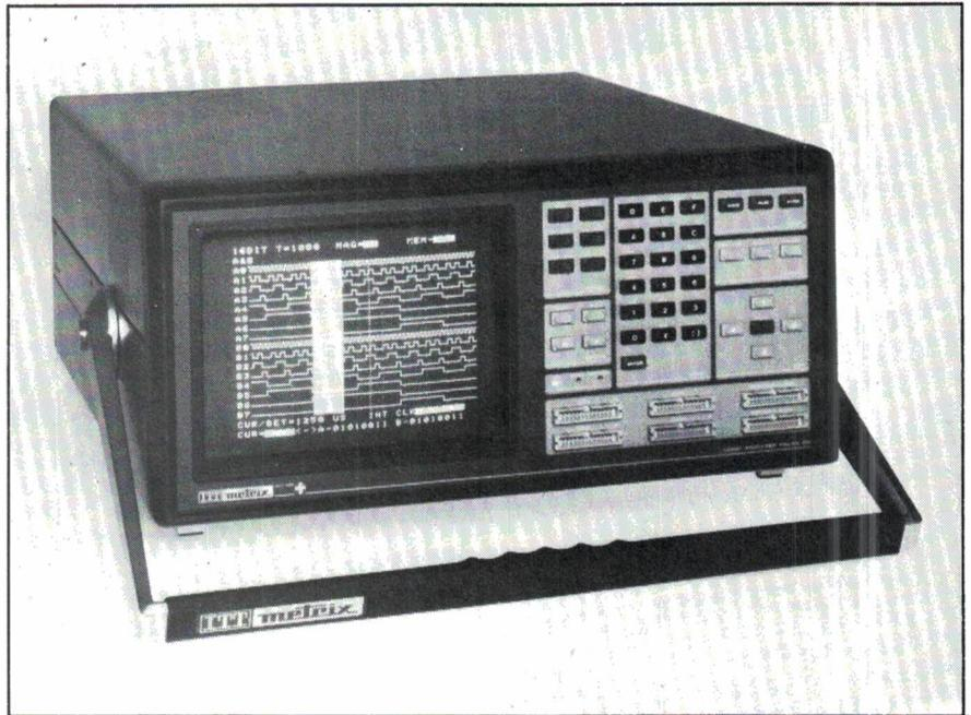
tème de capture des parasites (« glitches ») de 5 ns, fonctionne sur 16 voies simultanément.
