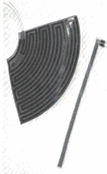
La résistance obtenue est ainsi totalement isolée électriquement et la conduction thermique entre la feuille de nickel-chrome et les faces externes est aussi élevée que possible (en effet, la conductibilité thermique du kapton à  $200\ \text{°C}$  est d'environ  $0,18\ \text{W/cm K}$ ).
