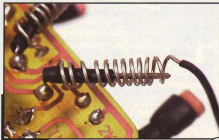
▶ Détails de réalisation des antennes "contact"
