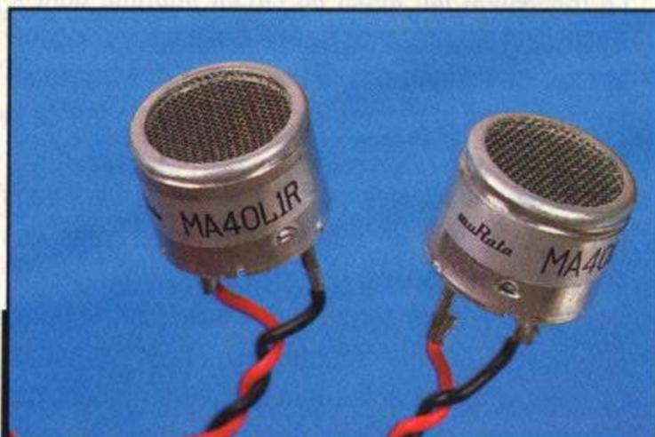
Ne pas confondre l'émetteur avec le récepteur
