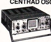
Bande passante du continu à 15 MHz (à ± 3 dB). Voies A et B (entrées sur semi-conducteurs à effet de champ). Bases de temps décalées et étalonnées de 5 ms à 1 µs. Expansion x X5. Entièrement à semi-conducteur. Tube très lumineux de 6 x 5 cm. Déclenchement au seuil ou automatique. Synchro intérieure ou extérieure. Polarité + ou -. Filtrés TV (ligne et image). Alimentation 220/240 V. Dimensions 11,7 x 31,5 x 26 cm.
