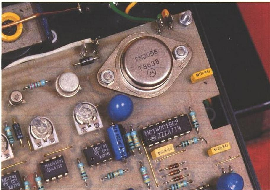
Gros plan sur le transistor de puissance 2N3055.
