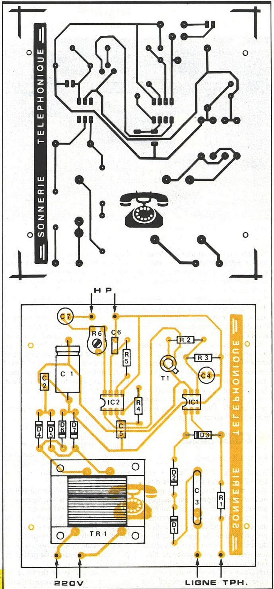
Détails de réalisation à l'échelle. **Fig. 3 et 4**
