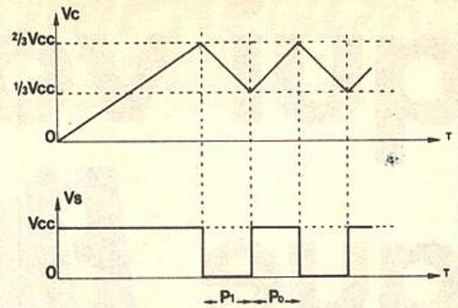
rapport cyclique de 50 %, il suffit de définir  $R_1$  et  $R_2$  pour obtenir  $I_1 = 2 I_2$  !  $V_c$  est un signal triangulaire variant de  $V_{cc}/3$  à  $2 V_{cc}/3$  et  $V_s$  est le signal rectangulaire associé.
