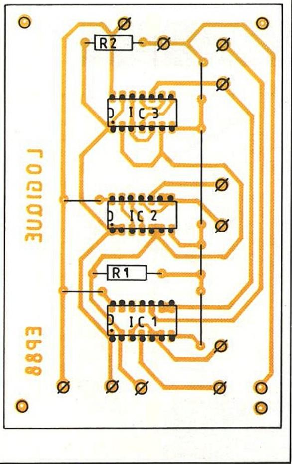
Fig. 3 Tracés des circuits imprimés et implantations des éléments.
