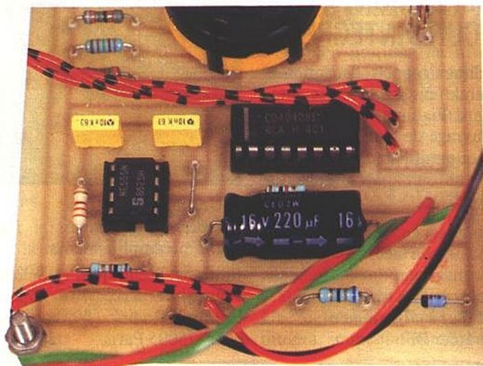
Ensuite on mesure sur un calibre un condensateur dont la valeur est connue et on corrige l'indication du cadran grâce à l'ajustable A<sub>4</sub>. Lors de la mesure de condensateur, quand l'appareil indique la valeur du condensateur mesuré, il faudra vérifier que le calibre supérieur à celui utilisé confirme la mesure précédente pour éviter toute lecture erronée. Pour les calibres 10 µF et 1 mF, le commutateur de droite doit être vers le haut, et vers le bas pour les autres calibres.
