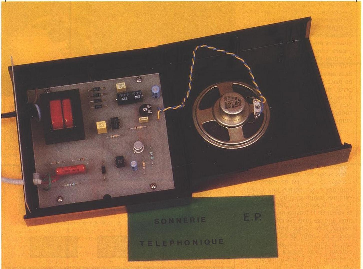
par le pont de Graetz, cette tension est ensuite filtrée par les condensateurs  $C_1$  et  $C_2$  afin d'éliminer les fréquences parasites. A cet étage, nous obtenons une tension dépassant largement les 20 V. L'auteur l'a prévu ainsi car  $IC_2$  ne peut fonctionner avec une tension inférieure à cette dernière.
