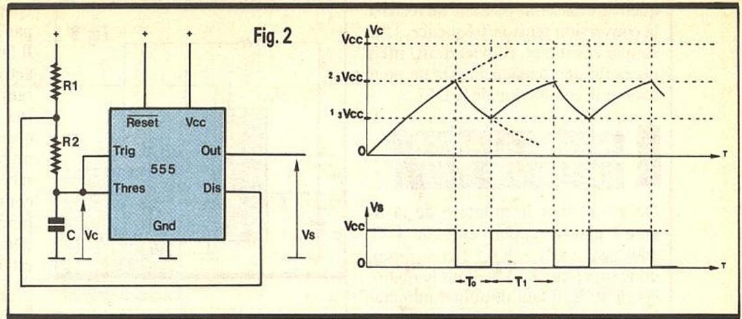
tor. Usuellement,  $T_0 \ll T_1$  et on pourra considérer la période égale à  $T_1$ . Le signal en  $V_c$  est en dents de scie exponentielle. Ce montage sera utile pour générer des impulsions, dont la durée ne nécessite pas de précision. La fréquence, par contre, sera définie par  $R_1$  et C.
