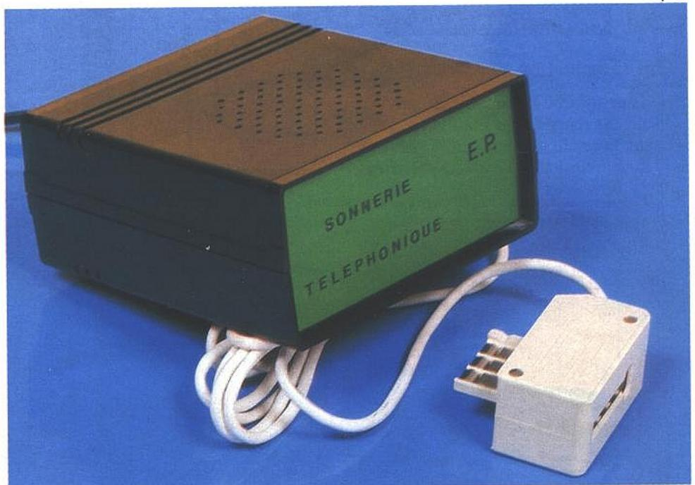
porte ce que nous connaissons tous, la tonalité. Bien entendu, le signal qui nous intéresse est celui de l'appel. En se référant au synoptique présenté à la figure 1, nous voyons que lorsqu'il arrive sur la ligne téléphonique, il est d'abord détecté, puis transformé par l'étage utilisant un photocouleur. Ce
