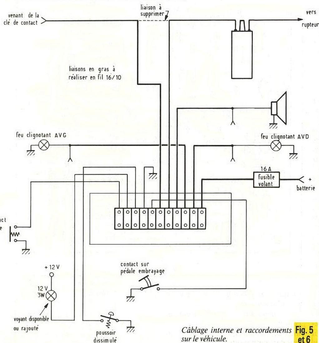
Câblage interne et raccordements sur le véhicule. **Fig. 5 et 6**
