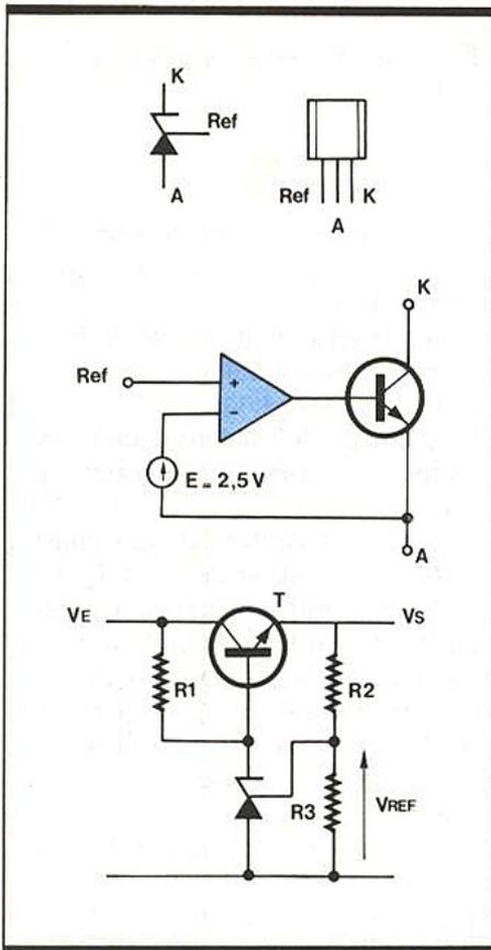
**Fig. 1** Diode zener programmable – équivalent de la « TL431 ». Alim. avec transistor ballast.
