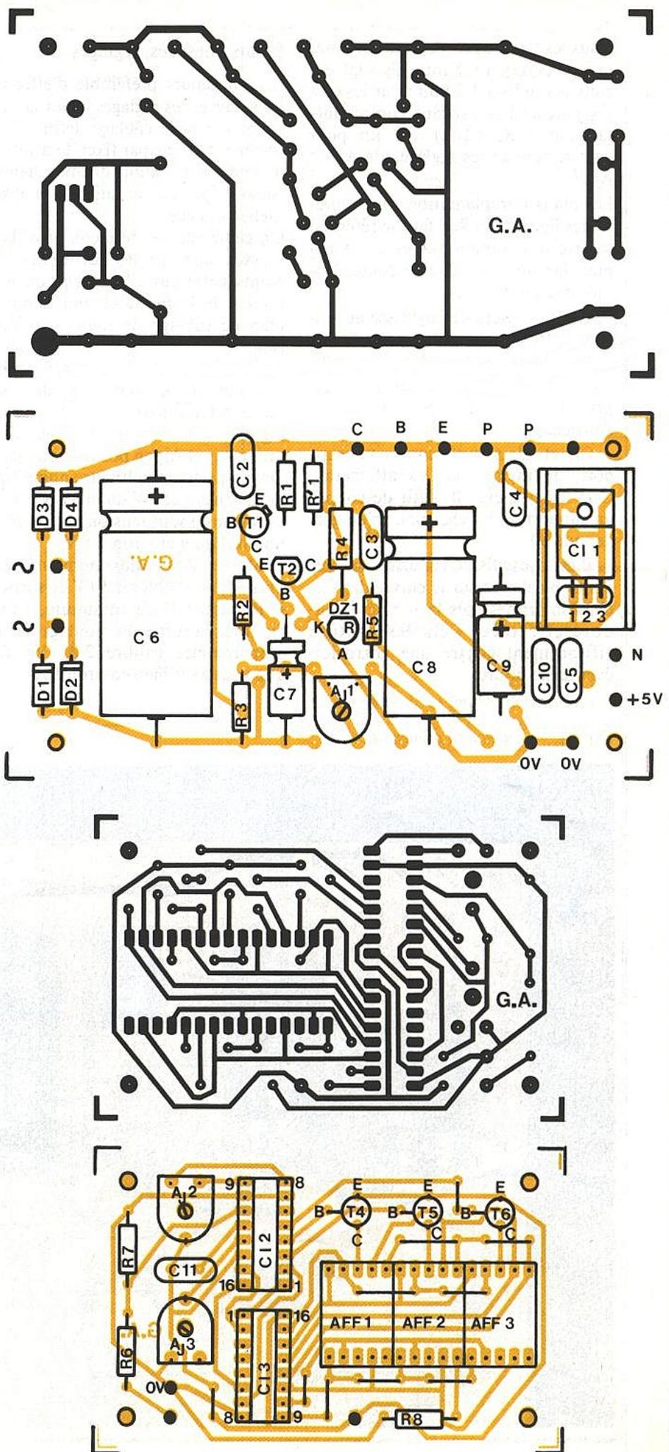
Tous les trous sont, dans un premier temps, percés à 0,8 mm. Ils sont ensuite agrandis à 1,2 mm pour les cosses poignard et certains composants (ajustables, R<sub>4</sub>, CI<sub>1</sub>...); à 3 mm pour les fixations et les réglages de Aj<sub>2</sub> et Aj<sub>3</sub>.
