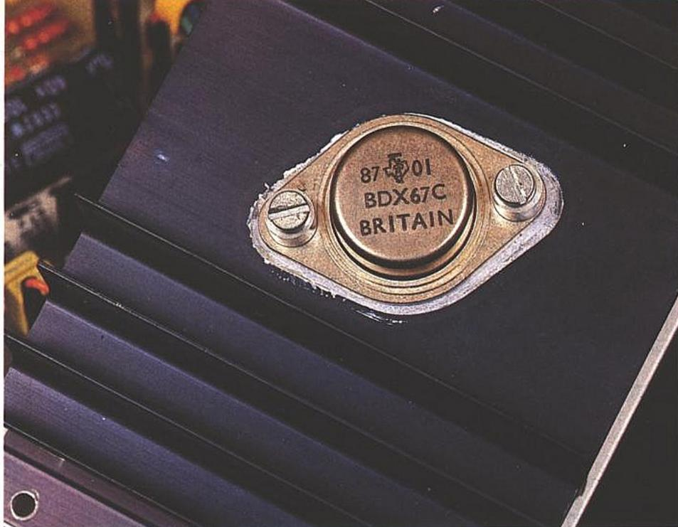
Photo 5. - Mise en place du transistor sur son dissipateur.
