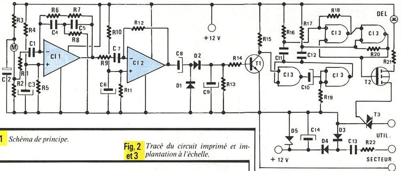
Fig. 1 Schéma de principe.
