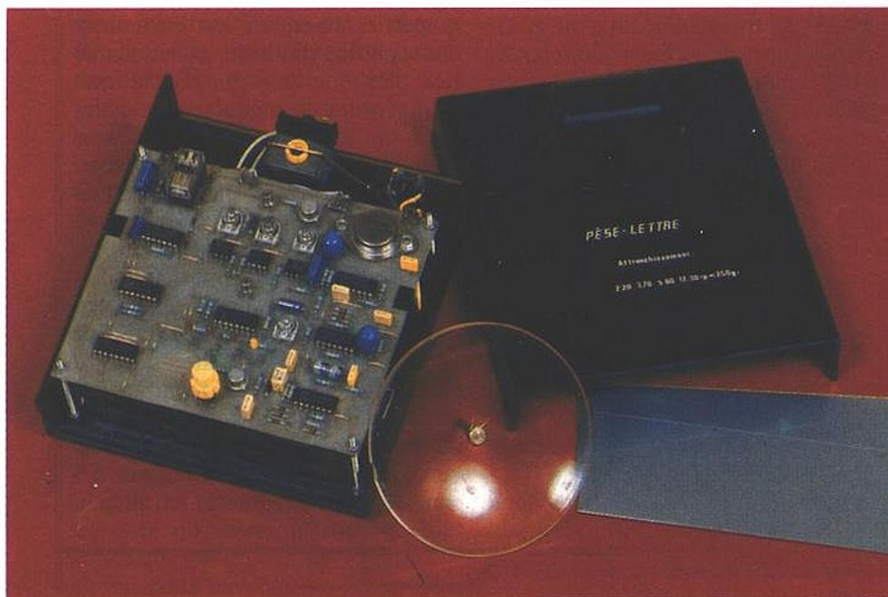
Deux coffrets Teko permettent l'insertion du montage.
