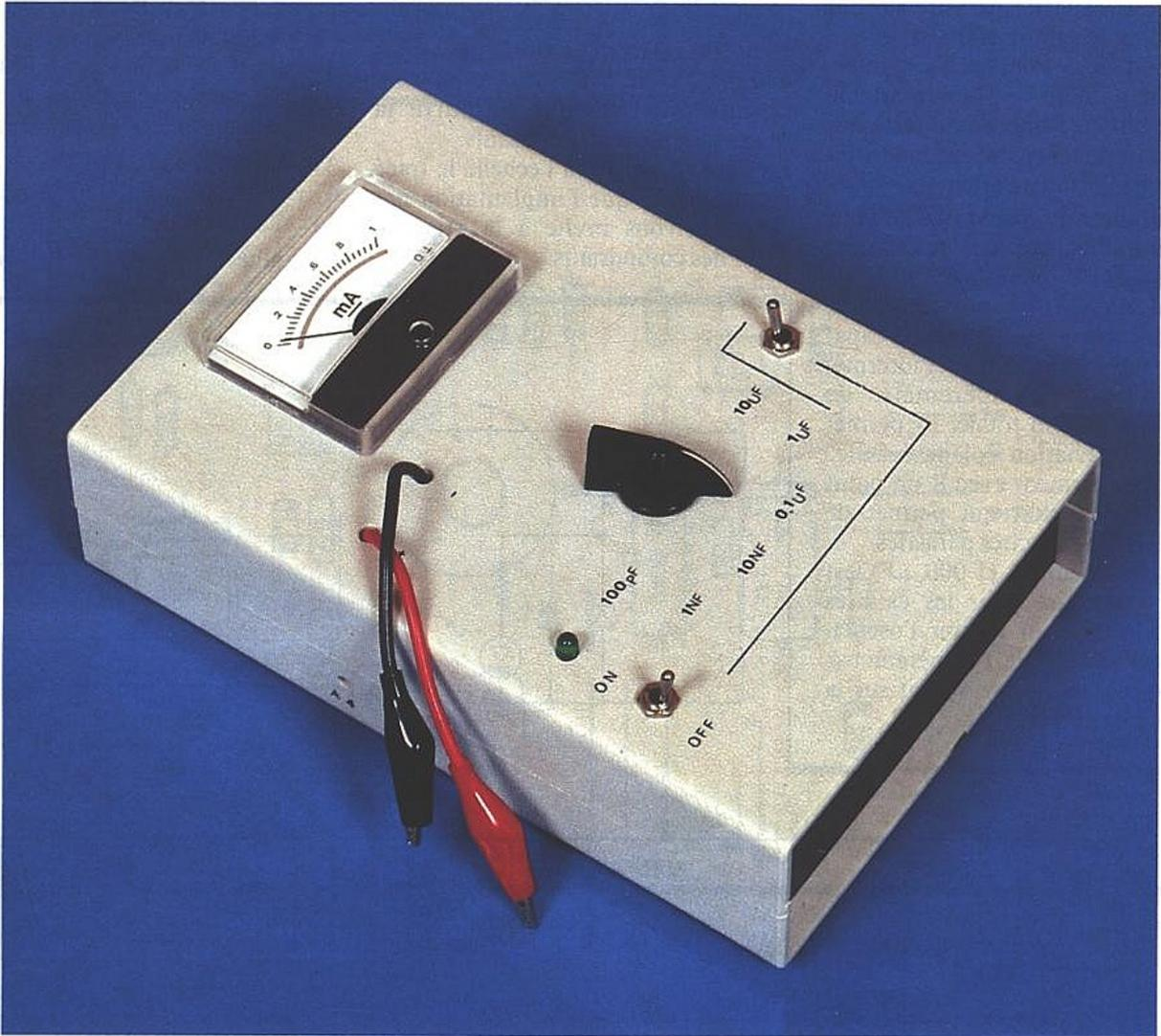
**L**es six calibres s'échelonnent de la façon suivante : 100 pF, 1 nF, 10 nF, 100 nF, 1  $\mu$ F et 10  $\mu$ F. La lecture s'effectue sur un milliampèremètre de tableau. L'alimentation se réalise sous 9 V de tension, procurée par une pile 9 V.
