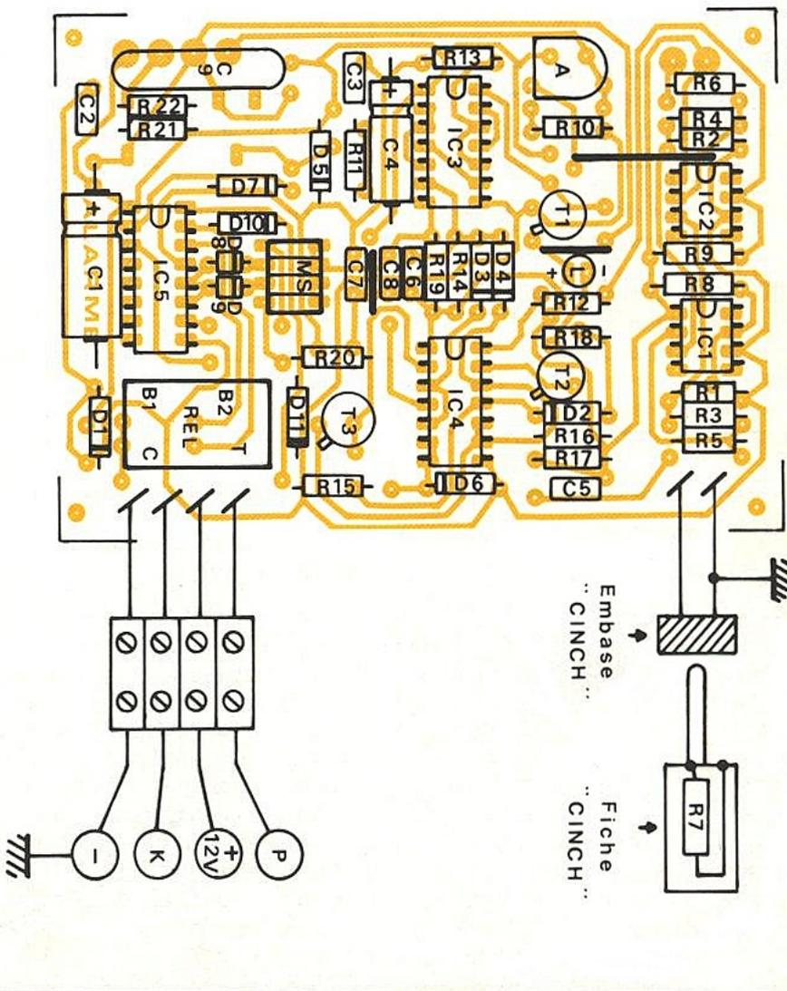
Fig. 5 et 6 Détails de réalisation à l'échelle.
