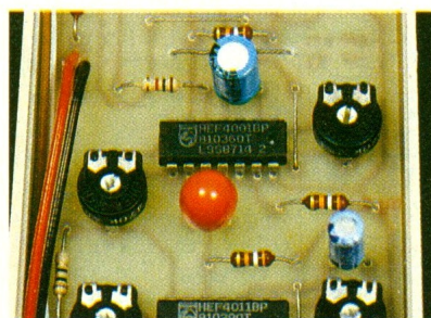
Photo 3. – En rouge, utilisation d'un condensateur tantalé.
