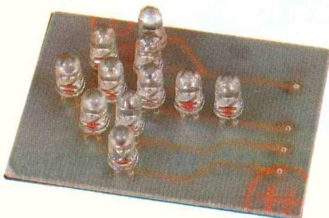
Que le lecteur se rassure, en constatant qu'il n'y a aucune résistance de limitation en série sur les LED, mais cette intensité brutale ne met pas en péril leur durée de vie, et ce n'est qu'à ce prix que l'on obtient un bel éclair bien vif, encore plus spectaculaire si l'on utilise des diodes LED à très haute luminosité. Les diodes  $D_4$ ,  $D_5$  et  $D_6$  protègent les transistors  $T_2$ ,  $T_3$  et  $T_4$  contre les surtensions selfiques à la coupure des bobines des relais.
