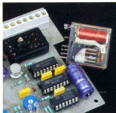
Photo 3. - Le relais repose sur un support.
