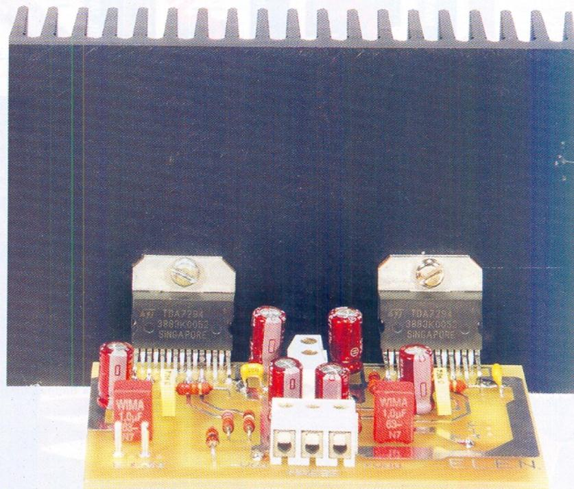
de monter deux TDA7294 en pont, comme l'indique le schéma électrique proposé en **figure 1**.
