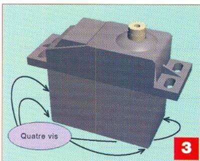
Démontez préalablement le palonnier. Ensuite, repérez les quatre vis, situées sous le servomoteur, elles maintiennent les trois parties du boîtier. Dévissez-les en utilisant un tournevis bien adapté et en tenant le servomoteur verticalement afin d'éviter
