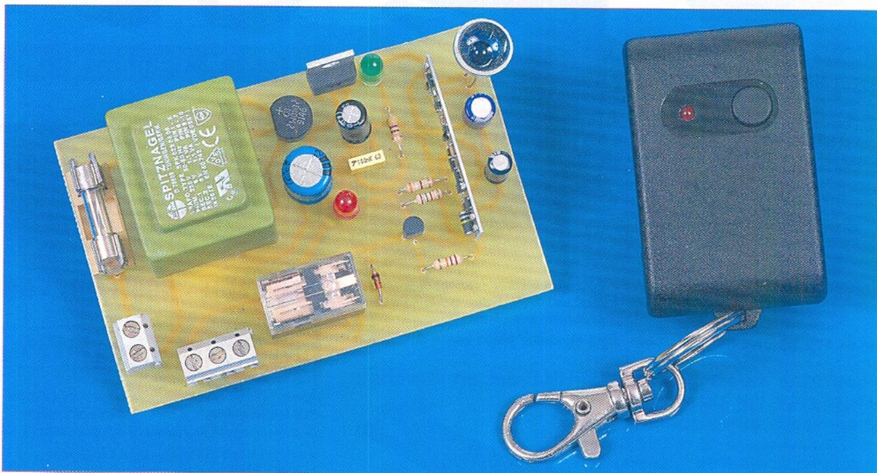
Nous avons détourné, de leur utilisation première, deux modules de gestion infrarouge prévus, à l'origine, pour la réalisation d'une barrière destinée à un éclairage automatique, à l'ouverture d'une porte ou au déclenchement d'un système d'alarme.
