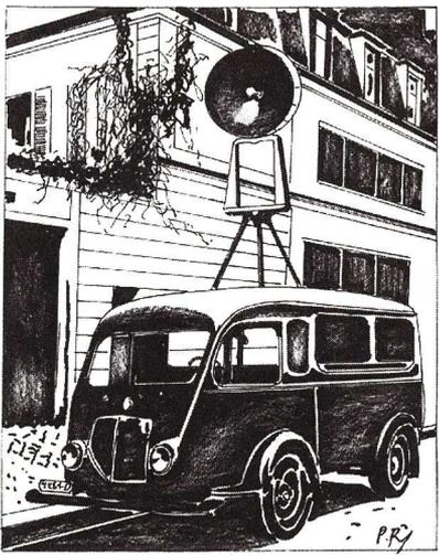
Le camion laboratoire d'essai de propagation en hyperfréquence
