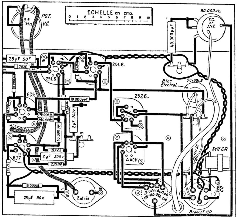
Le secondaire du transfo, en plus de sa liaison à la bobine mobile du dynamique, sert également de couplage contre-réactif avec le circuit cathode de la 6J7 (CR, résistance de 15 ohms) à travers une self spéciale et une résistance de 200 ohms. Ce mode de contre-réaction assure un relèvement du rendement des basses et aigüés.
