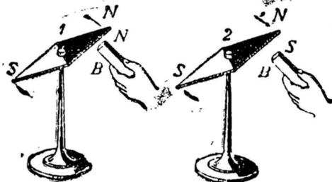
Fig. 19. — Comment reconnaître les pôles d'un aimant. — A aiguille aimantée montée en boussole; S, pôle sud; B, barreau aimanté dont il s'agit de reconnaître les pôles. — Le pôle nord du barreau est celui qui repousse le pôle nord de la boussole. Le pôle sud du barreau est celui qui attire le pôle nord de la boussole.
