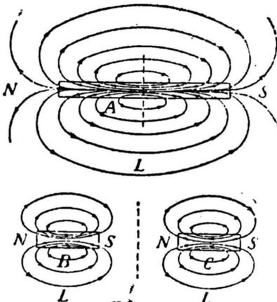
Fig. 23. — Apparition des pôles sur un aimant brisé. — A, barreau aimanté que l'on brise en deux tronçons B et C. — Un pôle sud S apparaît sur la cassure du barreau nord B et un pôle N apparaît sur la cassure du barreau sud C, par suite de la fermeture dans les barreaux des lignes de force L.
