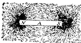
Fig. 21. — Spectre magnétique d'un barreau aimanté. — La limaille de fer dessine le spectre des lignes de force lorsqu'on lui imprime des secousses; A, barreau; N, S, pôles nord et sud.
