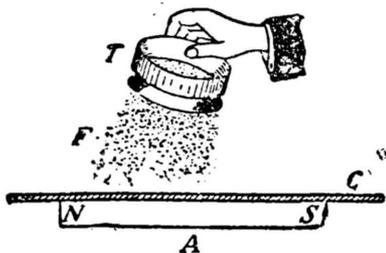
Fig. 20. — Comment obtenir le spectre magnétique d'un aimant. — A, barreau aimanté; N, S, pôles nord et sud; C, feuille de carton placée horizontalement sur le barreau; T, tamis à mailles fines servant à répartir uniformément sur le carton de la limaille de fer F, formant le spectre.
