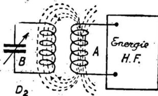
Fig. 2. — Absorption partielle de l'énergie à haute fréquence du circuit A par le circuit B qui lui est couplé.
