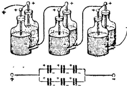
FIG. 16. — Association en série-parallèle de condensateurs. — Les groupes de condensateurs en série sont associés en parallèle ou encore les groupes de condensateurs en parallèles sont associés en série. Ces deux opérations reviennent d'ailleurs au même.
