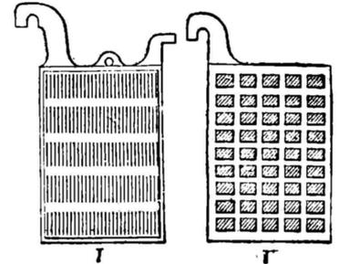
Fig. 4. — Plaques d'un accumulateur au plomb : I. Plaques de grande surface en plomb doux. — II. Plaques de plomb antimonieux à matière active rapportée dans des alvéoles.
