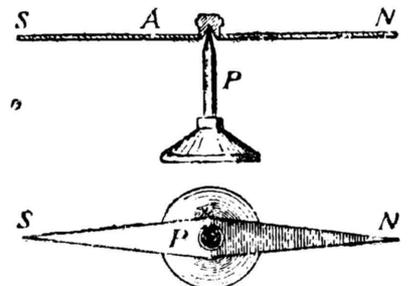
FIG. 18. — Aspect de la boussole magnétique. — A, aiguille aimantée ; N, pôle nord de l'aiguille ; S, pôle sud de l'aiguille ; P, pivot vertical, constitué par une aiguille posée sur un socle.
