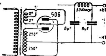
Le schéma d'une alimentation anodique utilisant le matériel que vous nous indiquez vous est donné par le schéma ci-dessus. Pour le filtrage, il vous faudra, avec votre bobine de self, utiliser deux condensateurs électrolytiques de 8 microfarads, isolés pour 400 à 500 volts, dont vous aurez soin, au montage, de respecter les polarités.
