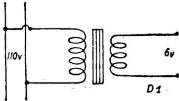
Fig. 1. — Transformateur abaisseur, donnant 6 V au secondaire lorsque la tension est de 110 V au primaire.
