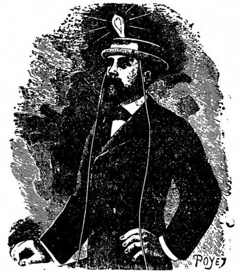
*Expérience sur les courants induits : l'opérateur porte un singulier chapeau, contenu par une bobine ronde parcourue par un courant de haute fréquence et surmontée d'un cercle métallique isolé formant secondaire. La lampe en contact avec le cercle s'allume.*
