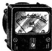
de 0 à 1 mA : 0,2 ; 0,4 ; 0,6 ; 0,8 ; 1 mA. Ils sont équipés d'un cadran rectangulaire de 50 × 50 mm avec vis de remise à zéro. Leur profondeur est de 35 mm. Ces milliampèremètres sont d'une utili-
