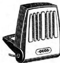
Du type piézoélectrique, les cristaux sont protégés de l'humidité et peuvent fonctionner jusqu'à une température de 45° C. Sortie : - 52 dB 1 V/dyne/cm<sup>2</sup>. Fréquence de réponse 30 à 8 000 c/s.
