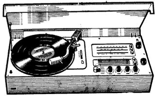
**BRAUN « AUDIO 1 »** - Chaîne stéréo Hi-Fi entièrement transistorisée (30 transistors) - Ampli-préampli stéréo 2x14 watts - Tuner AM PO-GO-OC et FM - Stéréo Multiplex incorporé, sensibilité AM 2 mV/50 mW, sensibilité MF 1,5 mV/26 dB. Courbe de réponse 30 à 30 000 Hz, taux de distorsion au-dessus de 1 % pour 1 000 Hz. Lecteur Shure M77, enceintes L. 46. Prix avec 2 enceintes L. 46... **2.800,00** « TC 20 », 2 x 5 watts. Prix avec 2 enceintes L. 44... **1.650,00**
