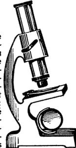
Sur pied fixe, tube chromé, statif fonte laquée, mise au point par rampe hélicoïdale, oculaire à tirage, permettant les grossissements 150 et 200X. Hauteur : 150 mm. Livré dans un joli coffret cartonné contenant 2 préparations et quelques accessoires nécessaires à lafection des préparations.
