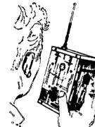
★ EMETTEUR-RECEPTEUR ERT4 entièrement transistorisé, 4 transistors. Emission pilotée par quartz sur la fréquence de 27 MHz. Réception par super-réaction. Portée de plusieurs centaines de mètres à quelques kilomètres, suivant les conditions géographiques.
