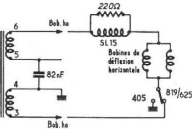
Pendant le temps de retour, aux bornes des bobines de déflexion horizontale, nous avons une forte surtension négative, aux bornes de l'enroulement THT nous trouverons une très forte surtension positive, car le sens d'enroulement est inversé par rapport à celui des bobines de déviation. Cette surtension est alors appliquée à la diode THT et à l'anode du tube cathodique.
