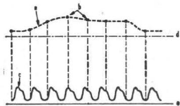
FIG. 1. — La technique de l'échantillonnage permet de faire apparaître une reproduction synthétisée du signal à examiner, un parallèle peut être établi avec l'image fixe que l'on obtient en observant un rouet tournant rapidement à l'aide d'un stroboscope optique. a) forme de l'onde reconstituée à la sortie ; b) échantillons affichés ; c) forme de l'onde à l'entrée ; d) base de temps lente ; e) base de temps rapide.
