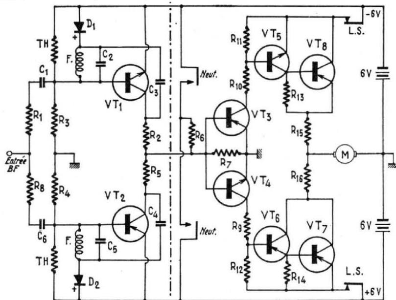
C1 : 0,02  $\mu$ F ; C2 : condensateur d'accord du filtre 1 ; C3 : 0,04  $\mu$ F ; C4 : 0,04  $\mu$ F ; C6 : 0,02  $\mu$ F ; C5 : condensateur d'accord du filtre 2.
