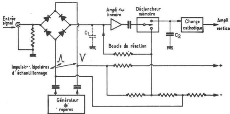
FIG. 5. — Dispositif à échantillonnage utilisant un système de correction d'erreur par circuit de réaction
