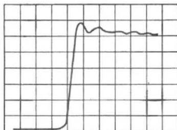
Fig. 7. — Allure d'une réponse type, une montée de 60 picosecondes que l'on distingue clairement
