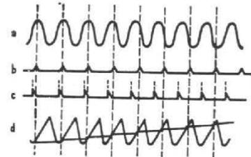
FIG. 4. — Formes d'ondes tracées en fonction du temps montrant les relations de base dans un oscilloscope à échantillonnage. a) forme de l'onde à l'entrée ; b) impulsions d'échantillonnage.
