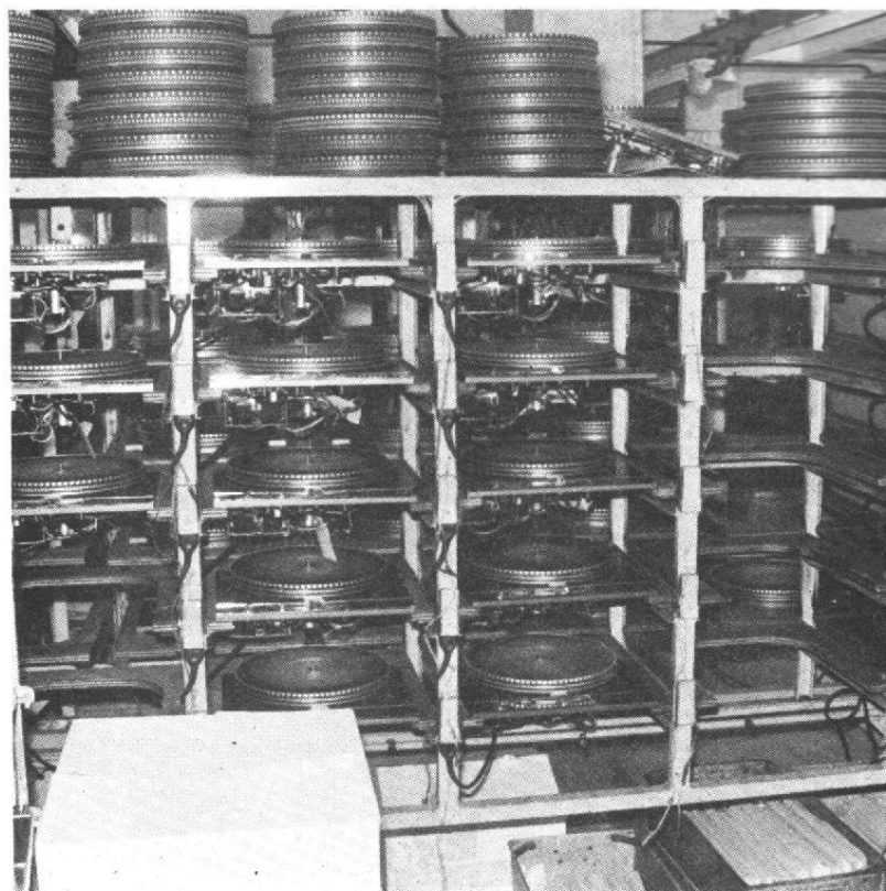
Toutes les platines 401 subissent un contrôle de résistance prolongée sur des bancs d'essais semblables à celui-ci.
