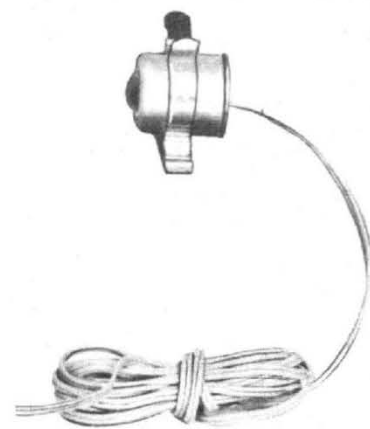
Fig. 6 - Vue du groupe photosensible une fois le montage terminé.
