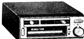
Peut recevoir tous types de cassettes (support mag-nétique Fe ou Cr), réponse 50 à 12 000 Hz, pleura-ge < 0,3 %, puis. tot. 44 WATTS music. (2 x 22 W) touche combinée AVANCE rapide/EJECTION cassette, auto-stop fin de bande, réglage du volume avec contr-ôle lumineux sur 2 rampes à LEDS multicolores, tonalité (Gr. et Aig. séparés), filtre « Loudness » balance stéréo, 2 sorties H.P. 4 à 8 ohms, alim. 12 Volts (— à la masse), L. 125, H. 46, P. 170 mm.
