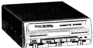
Permet d'écouter en suivant les 2 enregistrements d'une cassette sans avoir à éjecter ni retourner la cassette, sélecteur de pistes (1 - 3 ou 2 - 4) avec 2 voyants témoins du sens de lecture, touches AVANCE et RETOUR rapide (blocable) de la bande, EJECTION cassette, volume, tonalité, balance stéréo, puis. totale 40 WATTS music. (2 x 20 W), sorties H.P. 4 à 8 ohms, alim. 12 V (— à la masse), L. 120, H. 48, P. 150 mm.
