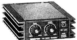
Puissance tot. 60 WATTS music. (2 x 30 W), réponse en fréquence 15 à 15 000 Hz, rapport signal/bruit 70 dB, contrôle de tonalité Gr. et Aig. séparé, impéd. H.P. 4 à 8 ohms, alim. 12 volts (— à la masse), L. 115, H. 40, P. 153 mm, livré avec accessoires de montage.
