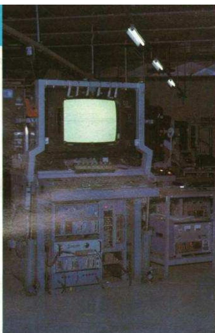
Photo 2. - Machine de réglage des déviateurs.
