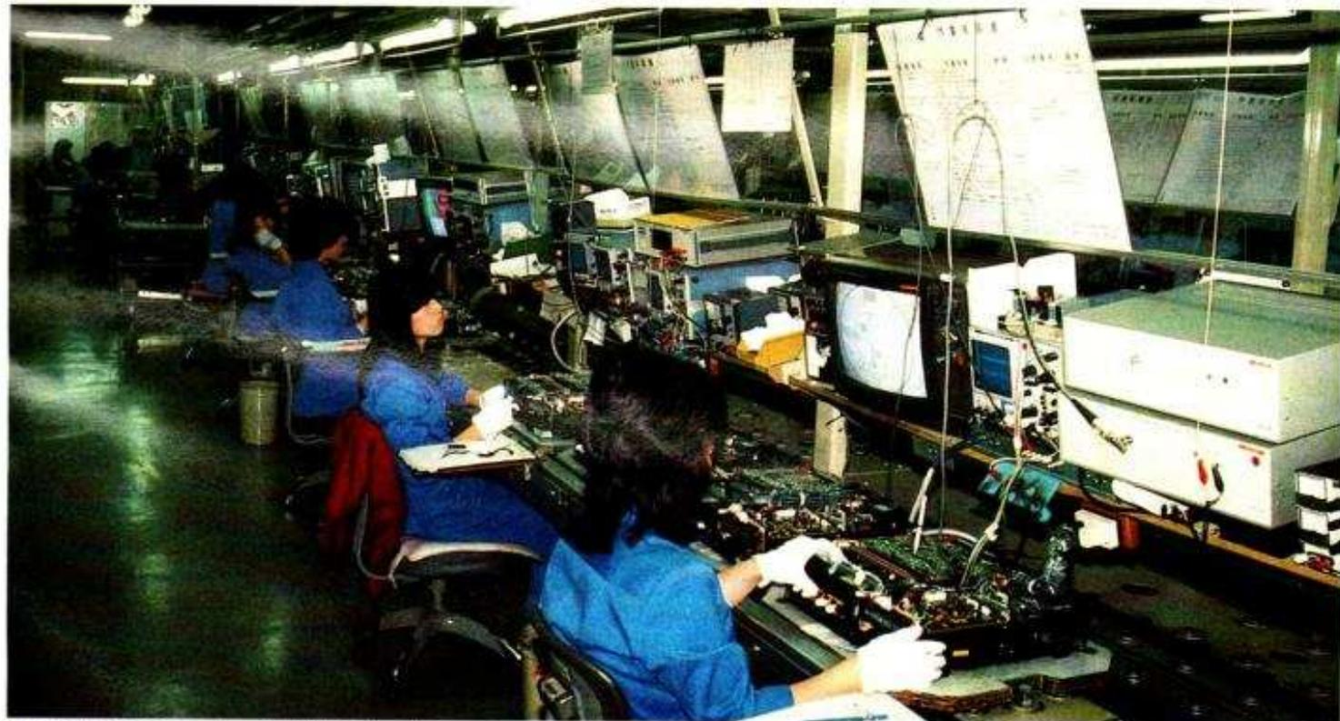
Yokohama : les réglages sur une ligne de fabrication de magnétoscopes.
