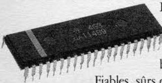
Le microprocesseur vidéo du système Stabicolor (marque déposée) assure la régulation nécessaire à chacun des canons : rouge, vert et bleu, lors de chaque image TV.
