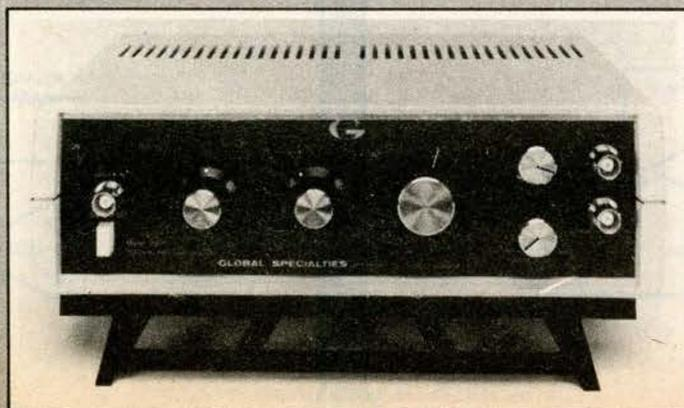
ailleurs. La commande d'amplitude à réglage continu permet, dans les sorties HI et LO et dans 600  $\Omega$ , de délivrer respectivement 10 mV à 30 V et 1 mV à 3 V. La forme d'onde peut également être décalée par rapport à la masse de  $\pm 15$  V sur la sortie HI et  $\pm 1,5$  V sur la sortie LO. Une entrée des rampes de tension permet de faire varier le rapport de la fréquence délivrée jusqu'à 1 000 : 1.
