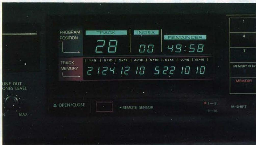
Photo 1. - Le panneau d'affichage très complet : en haut, le nombre de plages du disque ; à droite, le temps restant et, au-dessous, huit des morceaux programmés. Pour les huit autres, on doit enfoncer une touche.
