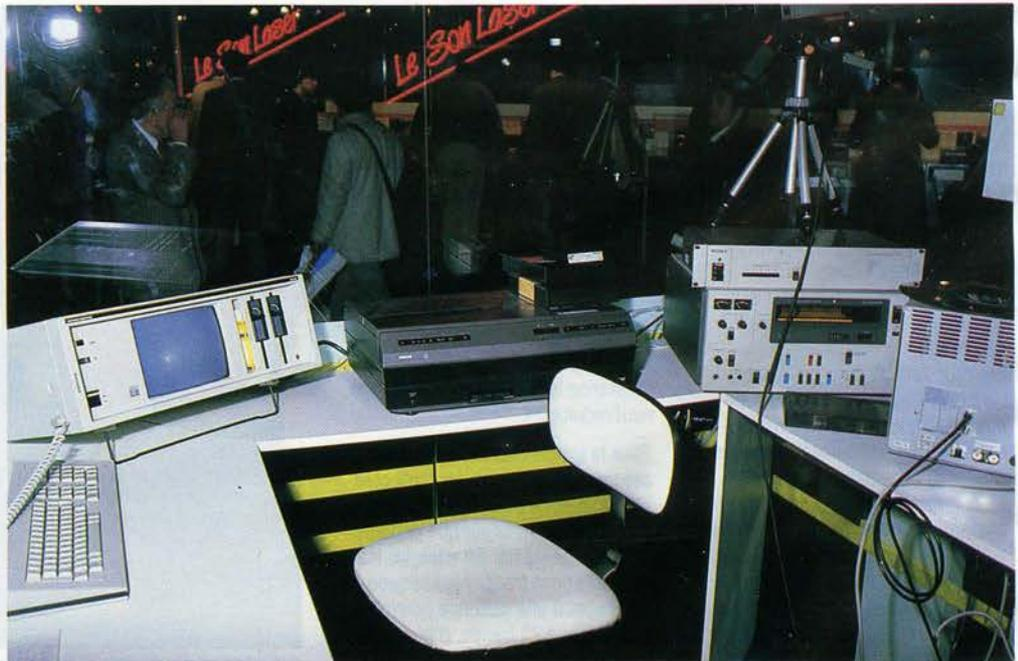
La cabine de programmation du Vidiwall : à gauche, nous avons un ordinateur style personnel, un P 2000 Philips compact ; au centre, se trouve le vidéodisque Laservision à cartouche de programmation ; à droite, c'est une autre source : un lecteur de cassette Umatic surmonté ici d'une caméra vidéo sur trépied (cabine de démonstration Portenseigne pour groupe de 9 moniteurs). (Photo 6.)
