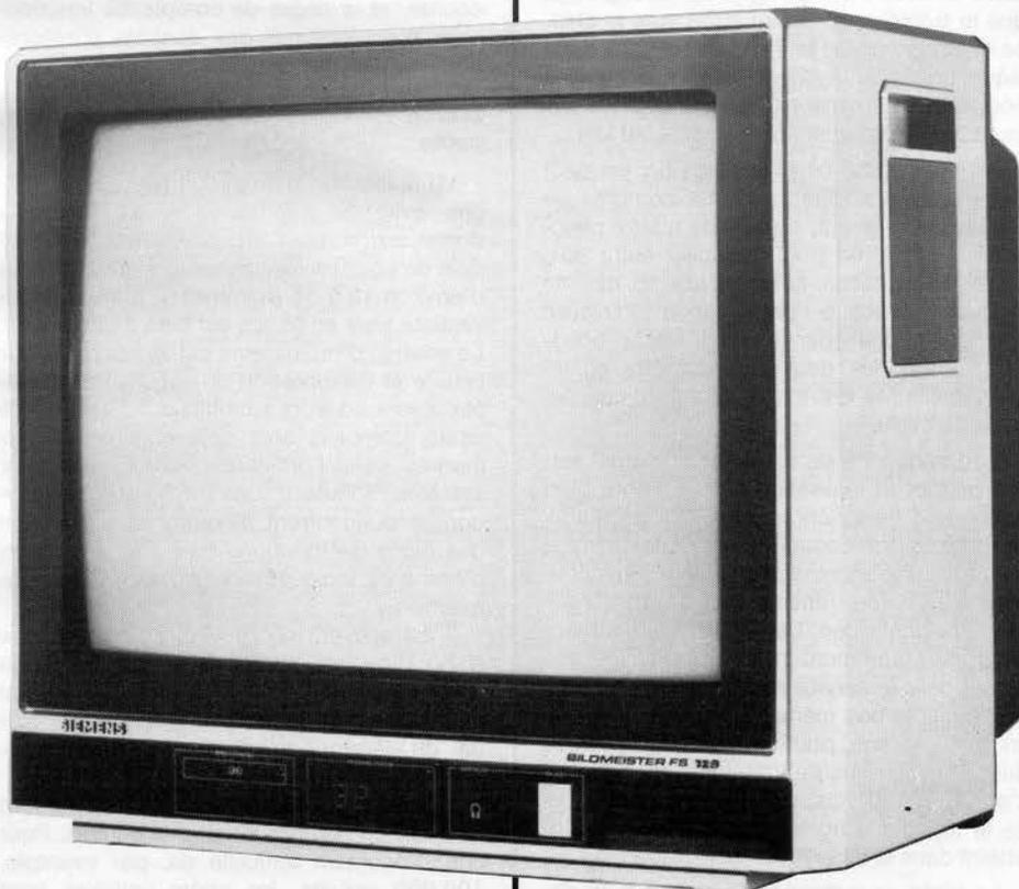
Téléviseur Siemens à tube MC4 Video-color 55 cm, « coins carrés », en partie numérisé pour le traitement du signal.
