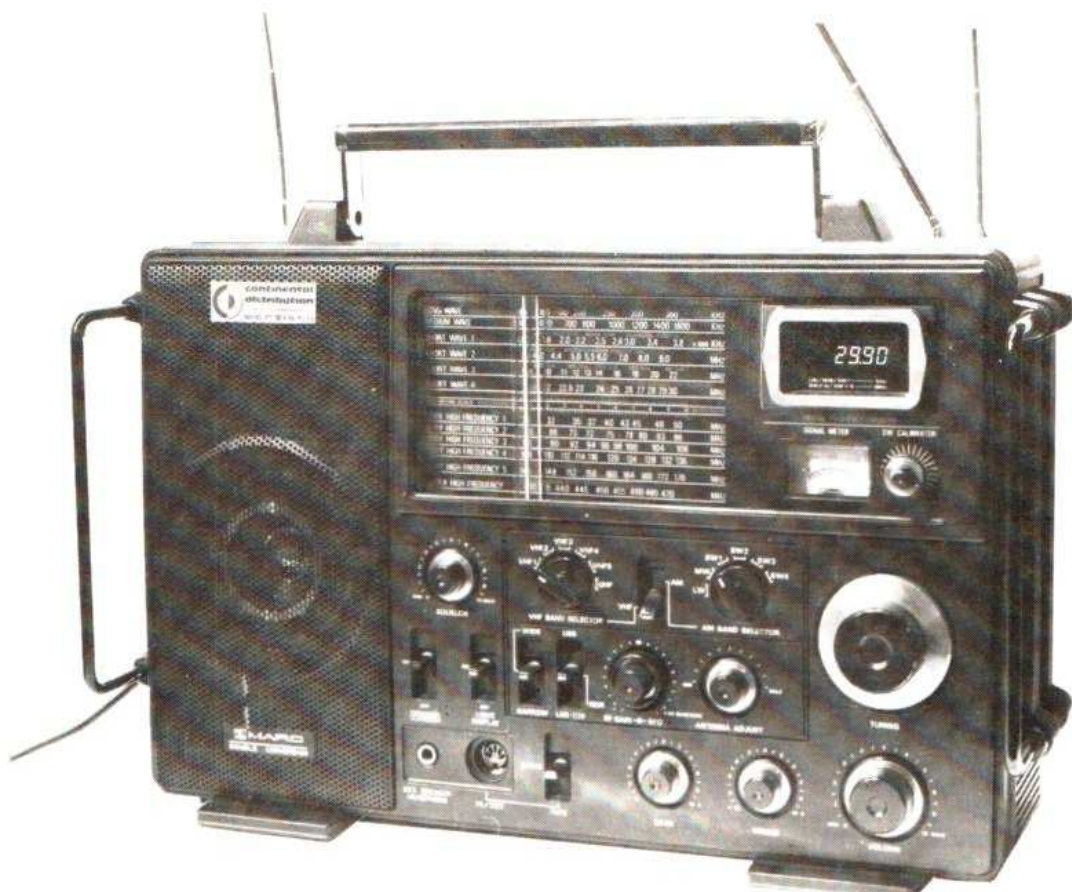
Technimarc IVR 82-F1. Récepteur 145 kHz-30 MHz (AM), 5 gammes VHF FM (30-176 MHz), une gamme UHF (430-470 MHz). Entièrement analogique. Ne contient donc pas de microprocesseur (ni mémoire ni scanner) susceptible de créer des perturbations (photo Continental Distribution).
