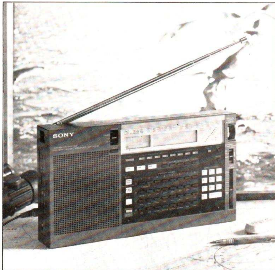
Sony ICF 2001 D. Récepteur 150 kHz-30 MHz, 76-108 MHz (FM), 116-136 MHz (Air). Mémoire 32 canaux, scanner. Particularité exceptionnelle : démodulation synchrone (photo Sony).
