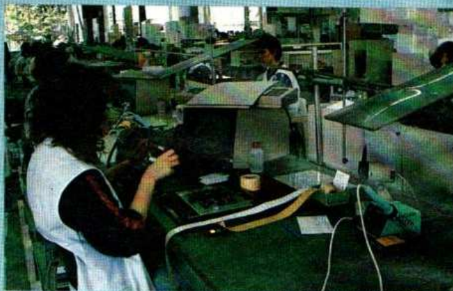
Vérification informatisée des platines électroniques (ici rotation du disque et démodulation EFM) des lecteurs CD.
