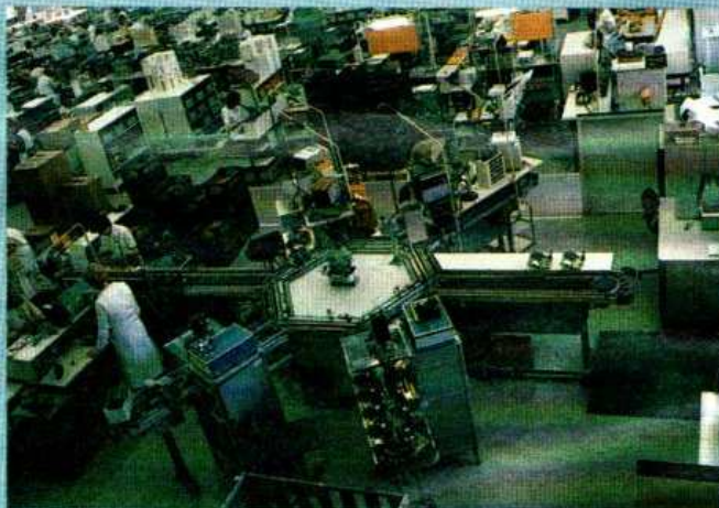
Vérification informatisée des platines électroniques (ici rotation du disque et démodulation EFM) des lecteurs CD.
