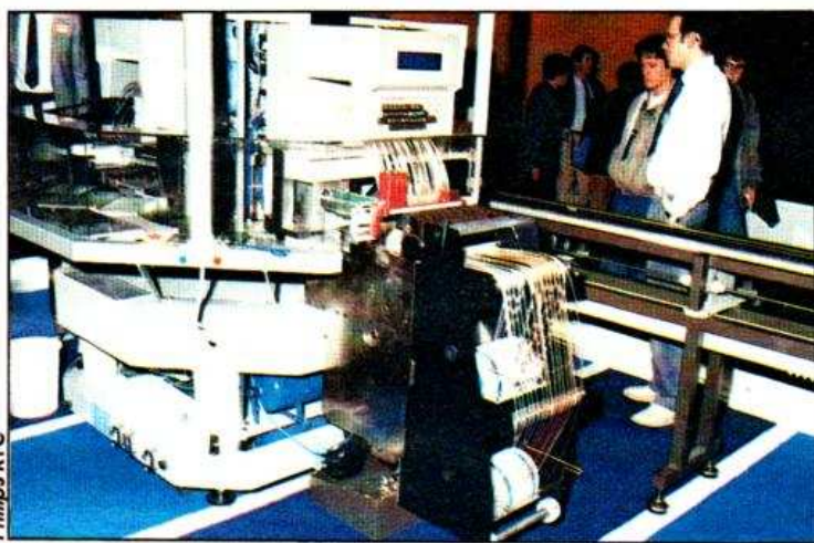
Machine d'implantation des composants en surface, deux postes sont ici équipés, un pour le montage de composants de petite taille en bobine (ici), l'autre, diamétralement opposé, pour l'implantation des circuits intégrés. Les circuits imprimés sont montés sur un carrousel.
