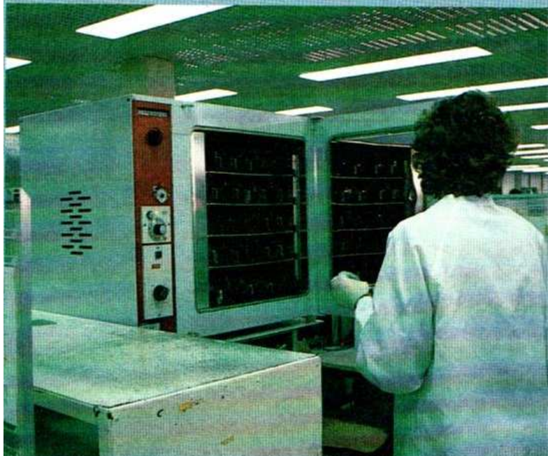
Fabrication des optiques : c'est comme chez soi, on trie les lentilles... ... et on les cuit au four (collage).
