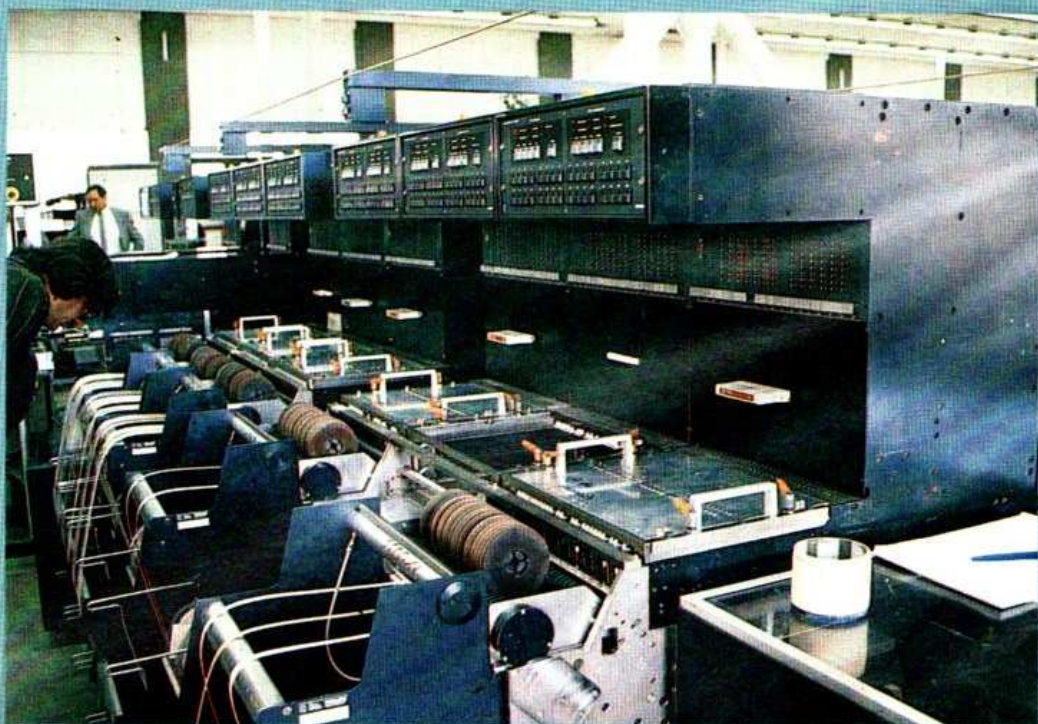
Bien que l'on soit en Belgique, terre d'élection des « Panasert » Matsushita, Philips utilise des machines à insertion d'origine américaine, ainsi que ses propres machines pour le montage des composants en surface (CMS, ou SMD).
