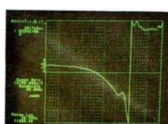
Courbe de phase de l'enceinte (une deux voies de chez Vecteur).
