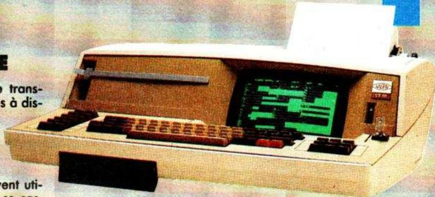
Photo D. - Téléimprimeur Sagem TX35 (mémoire disquette 5,25").
