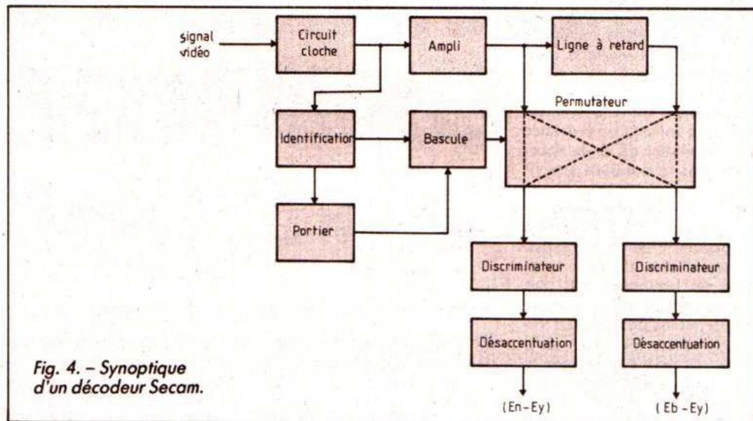
Fig. 4. - Synoptique d'un décodeur Secam.
