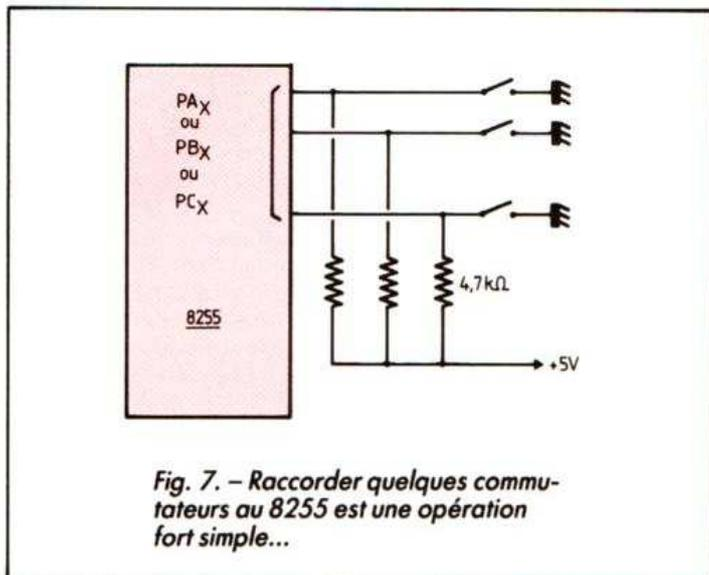
Fig. 7. - Raccorder quelques commutateurs au 8255 est une opération fort simple...
