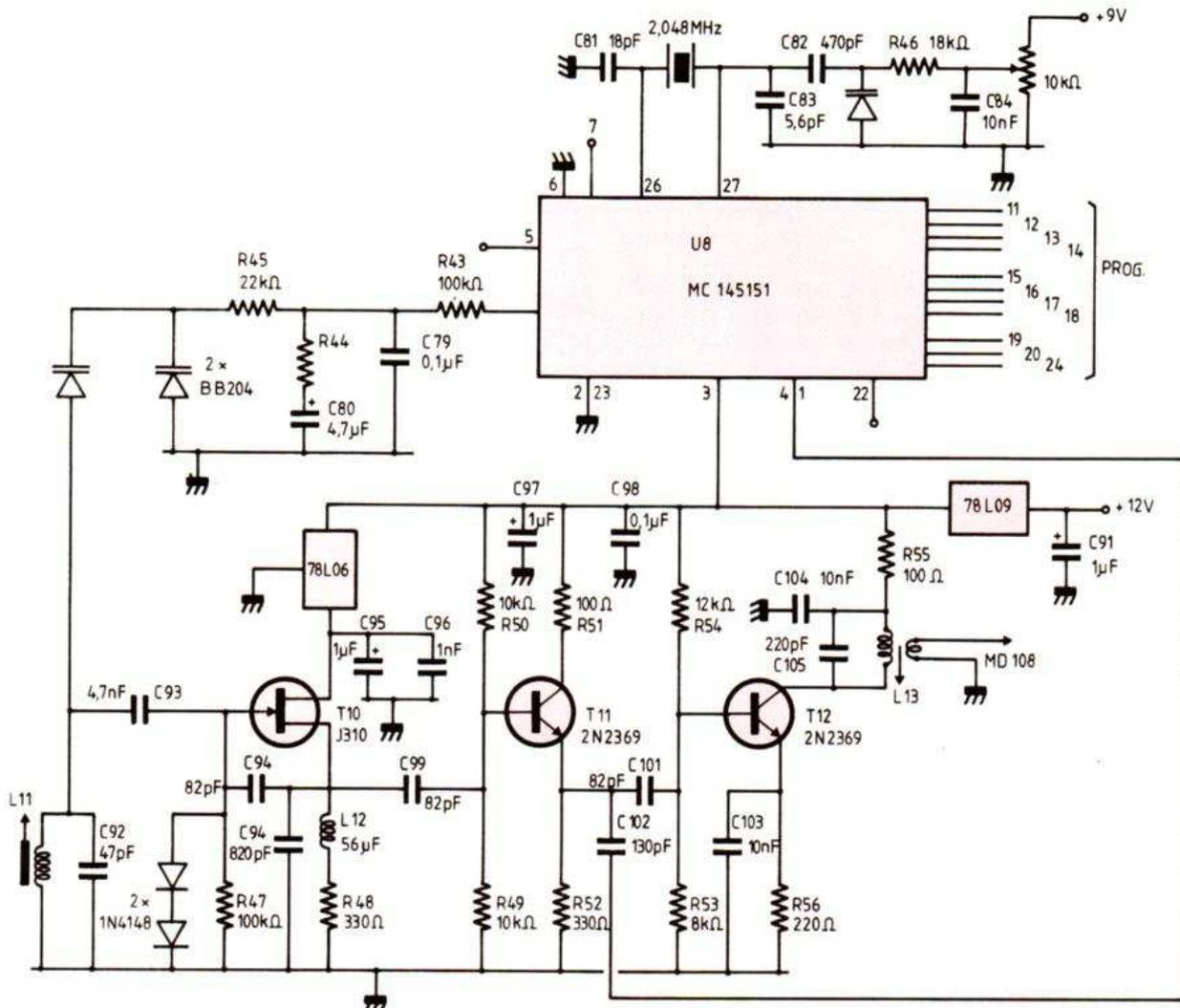
Fig. 3. - Schéma de principe du synthétiseur de fréquence.
