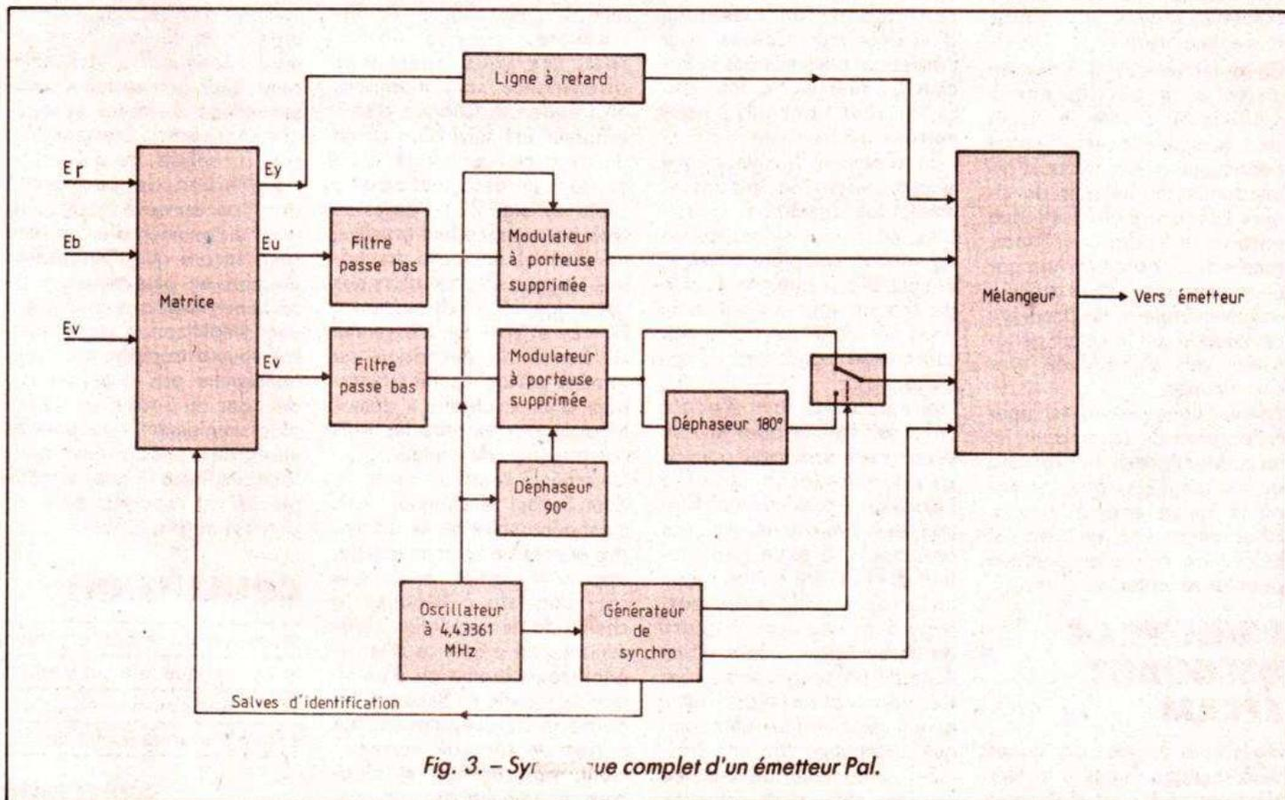
Fig. 3. - Synoptique complet d'un émetteur Pal.
