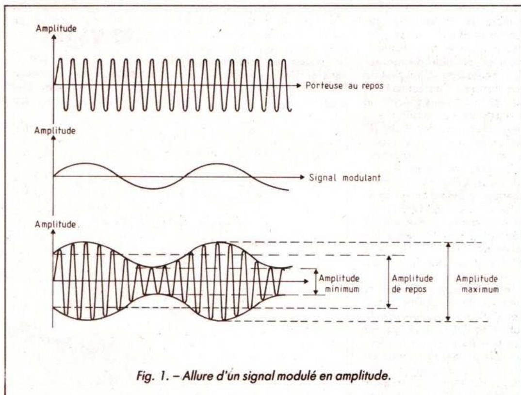
Fig. 1. - Allure d'un signal modulé en amplitude.
