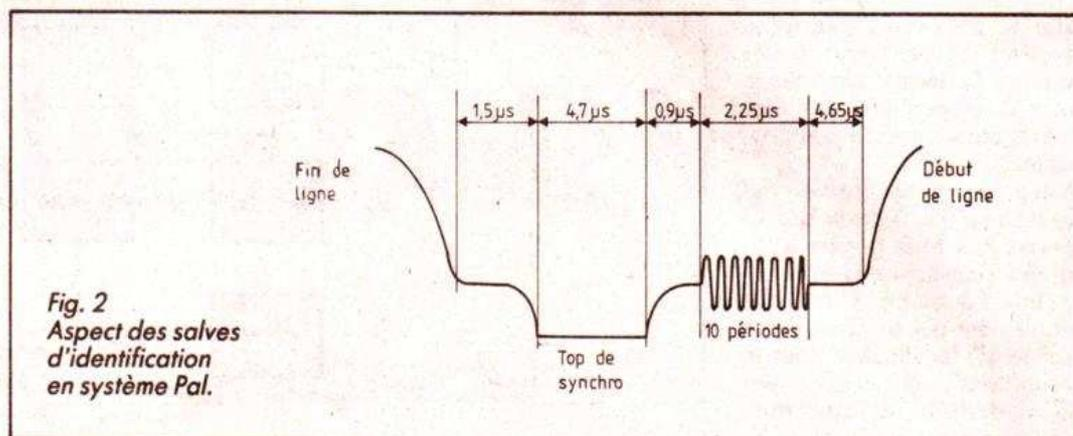
Fig. 2 Aspect des salves d'identification en système Pal.
