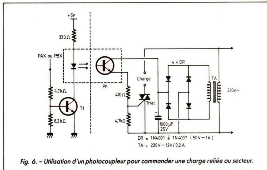
Fig. 6. - Utilisation d'un photocoupleur pour commander une charge reliée au secteur.
