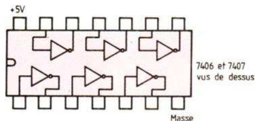
Fig. 3. - Commande d'une charge de faible puissance avec des circuits TTL à collecteur ouvert.
