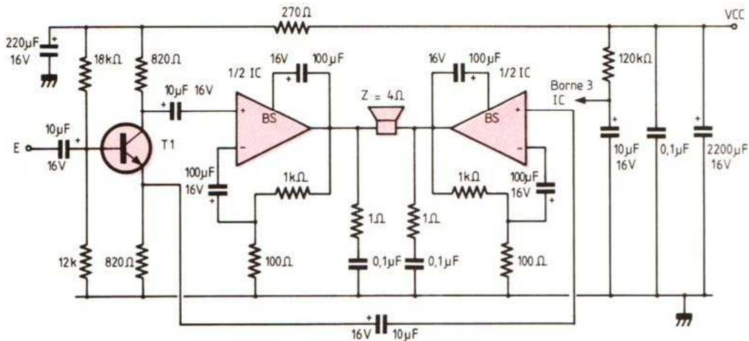
Fig. 1. - Schéma de principe de la section amplificatrice (un seul canal représenté).
