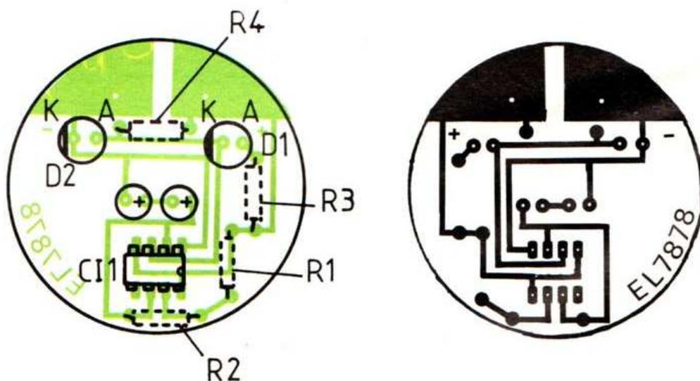
Fig. 2. - Implantation : côté composants, bouche, nez, yeux ; côté cuivre résistances.
