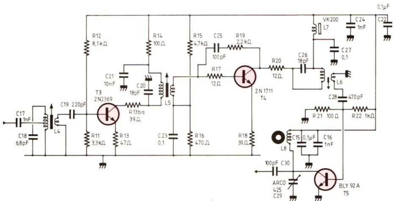
Fig. 2. - L'ampli de puissance HF.
