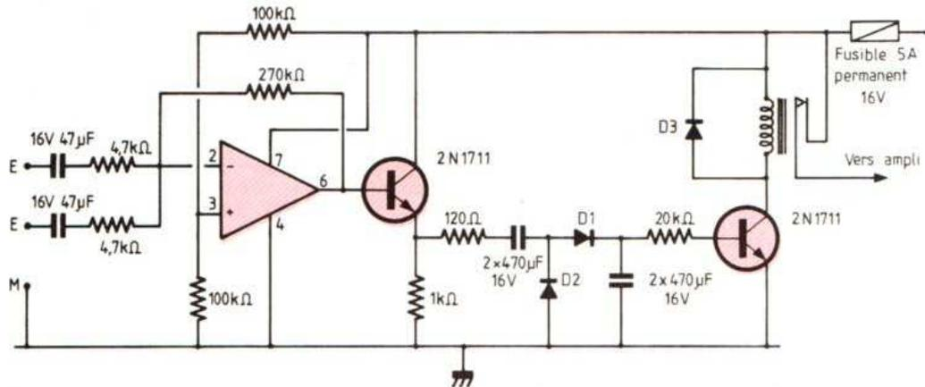
Fig. 2. - Schéma de principe du dispositif de mise sous tension.
