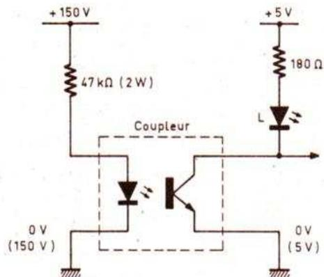
Fig. 17. - Détection du 150 V avec l'utilisation d'un photocoupler.
