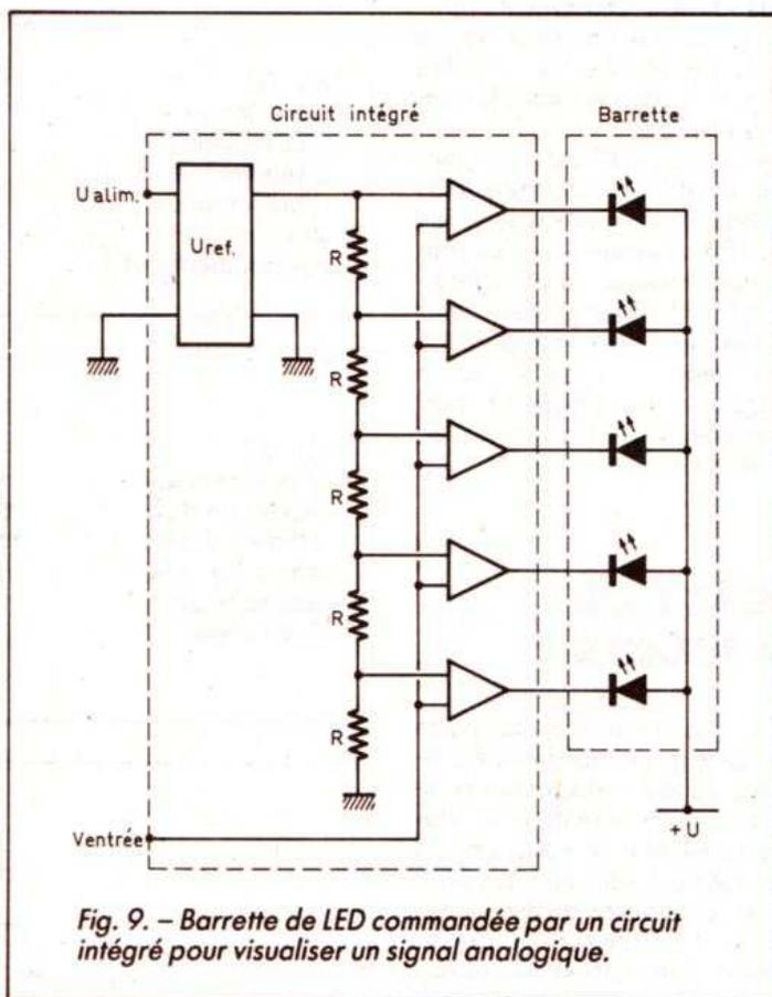
Fig. 9. - Barrette de LED commandée par un circuit intégré pour visualiser un signal analogique.
