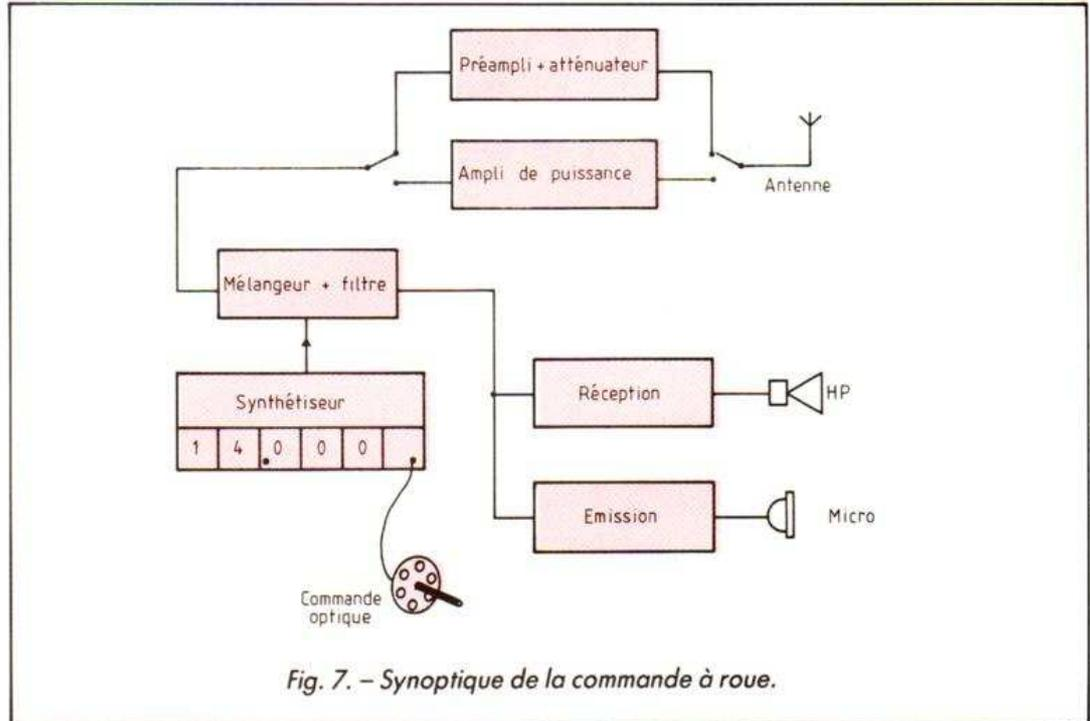
Fig. 7. - Synoptique de la commande à roue.
