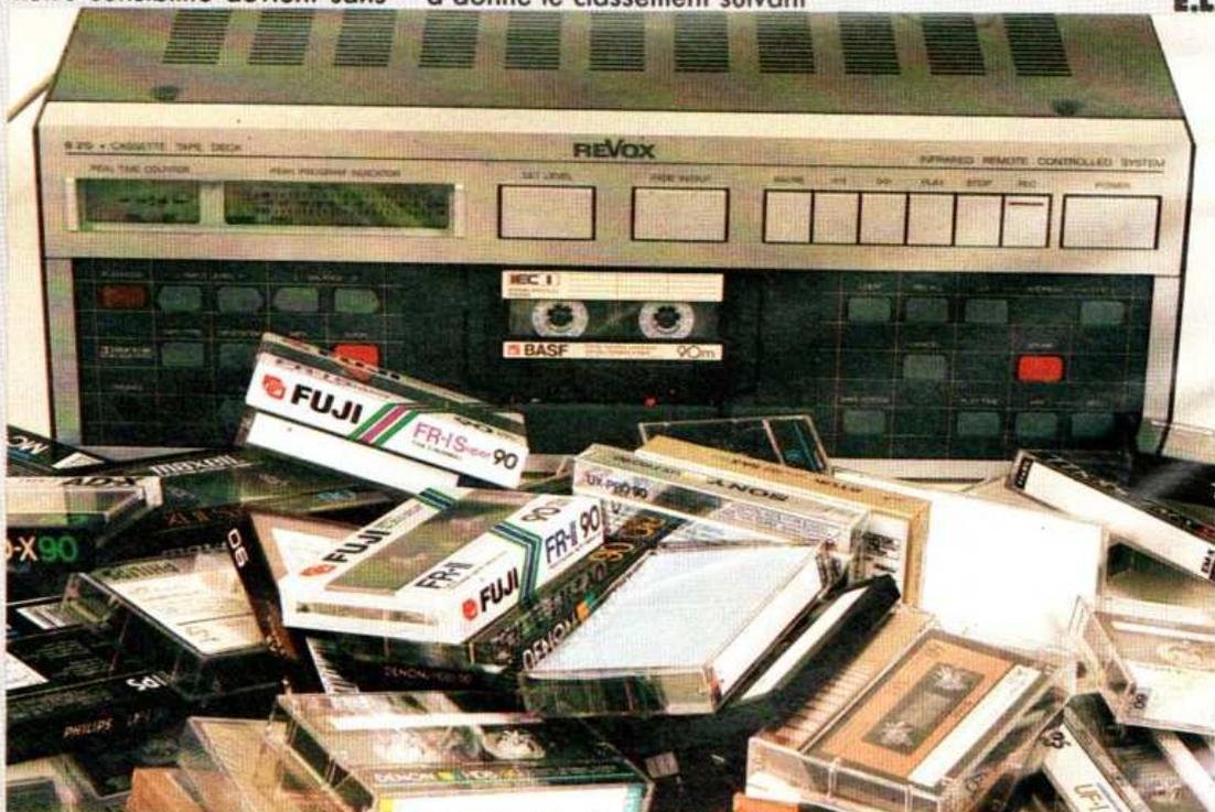
Le Revox B-215, pour les essais. La machine est prévue pour fonctionner sur les références IEC, mais peut s'accommoder d'autres types moyennant réglages.
