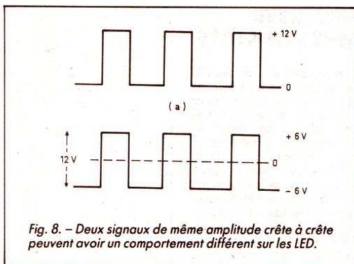
Fig. 8. - Deux signaux de même amplitude crête à crête peuvent avoir un comportement différent sur les LED.
