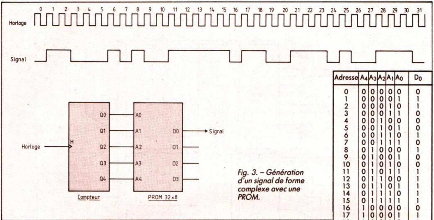
quelques secondes. En effet, il suffit de commander les lignes d'adresses de la PROM avec un compteur binaire commandé lui-même par l'horloge pour générer le signal voulu sous réserve d'avoir programmé cette mémoire avec les données indiquées figure 3. A chaque coup d'horloge, le compteur avance et adresse une case mémoire de la PROM. Un niveau logique haut ou bas est donc disponible sur D0 selon que l'on a programmé un 1 ou un 0 à cette adresse. Facile, n'est-ce pas ?
