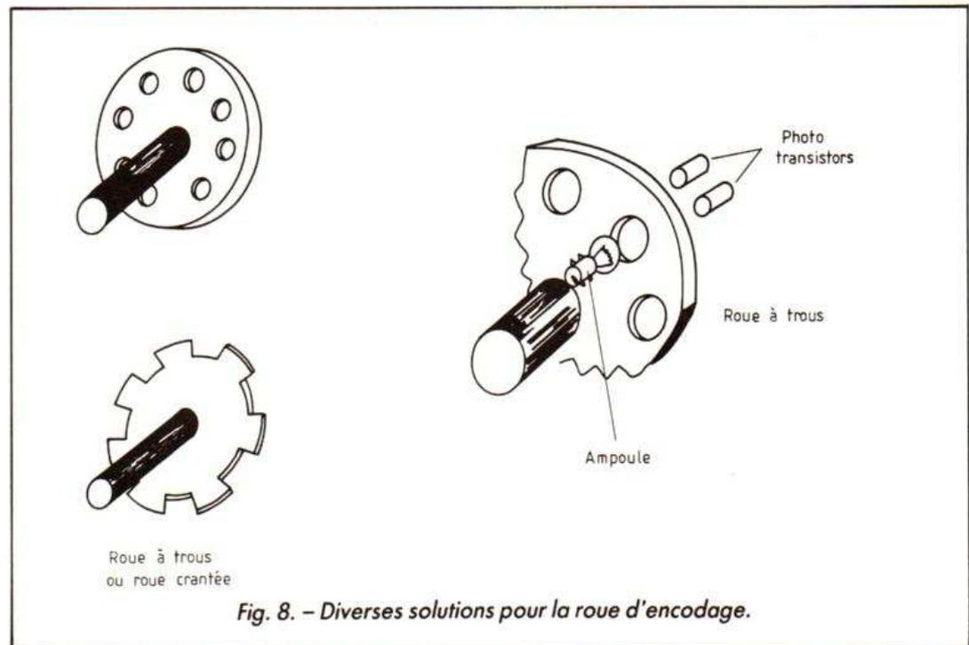
Fig. 8. - Diverses solutions pour la roue d'encodage.
