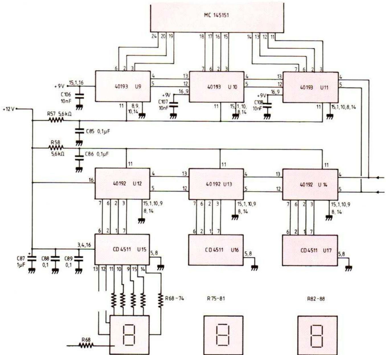
Fig. 4. - Schéma de principe du circuit de programmation et d'affichage.
