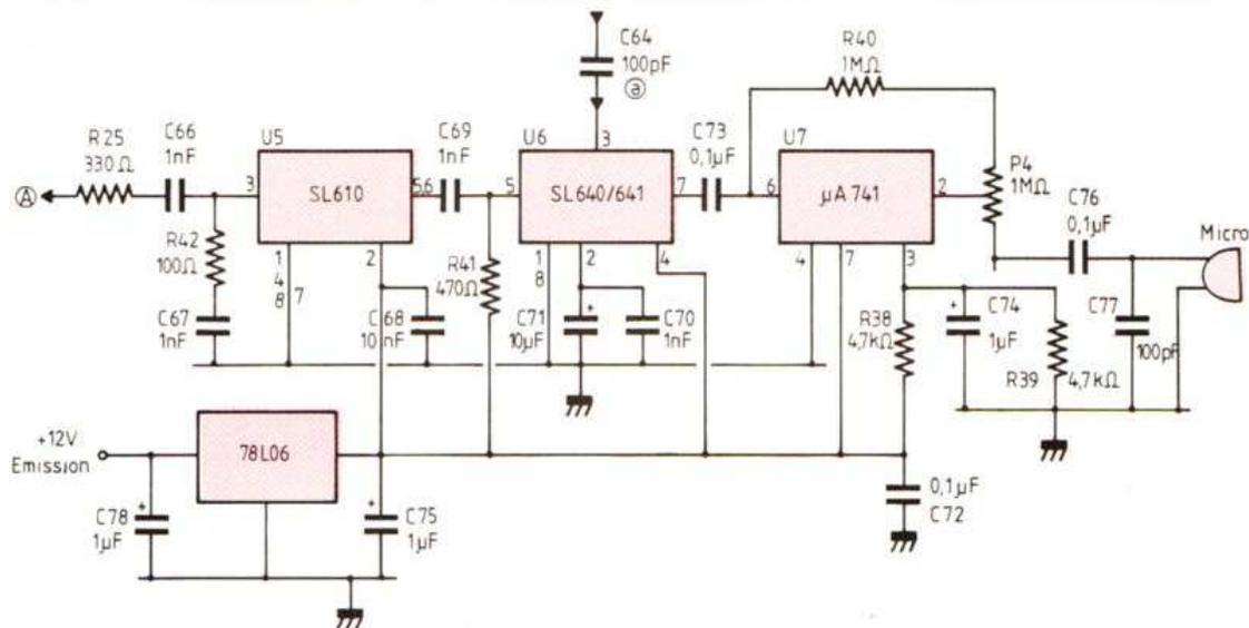
Fig. 1. - Préampli micro et mélangeur.
