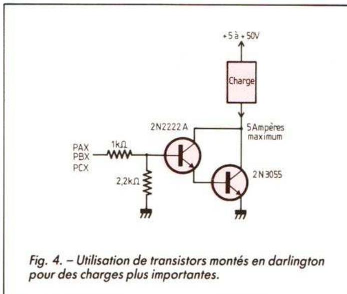
Fig. 4. - Utilisation de transistors montés en darlington pour des charges plus importantes.
