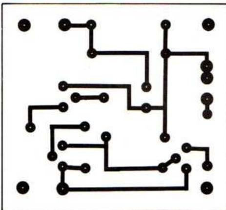
Fig. 2. - Le circuit imprimé, vu côté cuivre, échelle 1.
