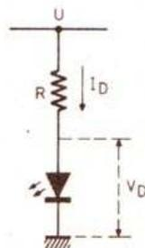
Fig. 1. - Montage de base d'une diode électroluminescente.
