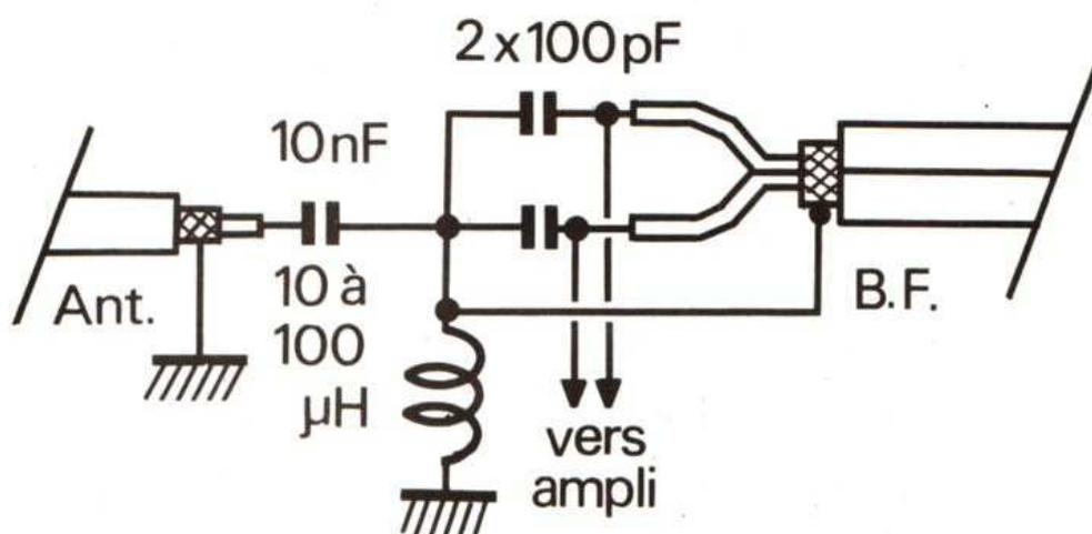
Fig. 5. - Le câblage de l'entrée sur un filtre HF permet d'utiliser les petites radios portables.
