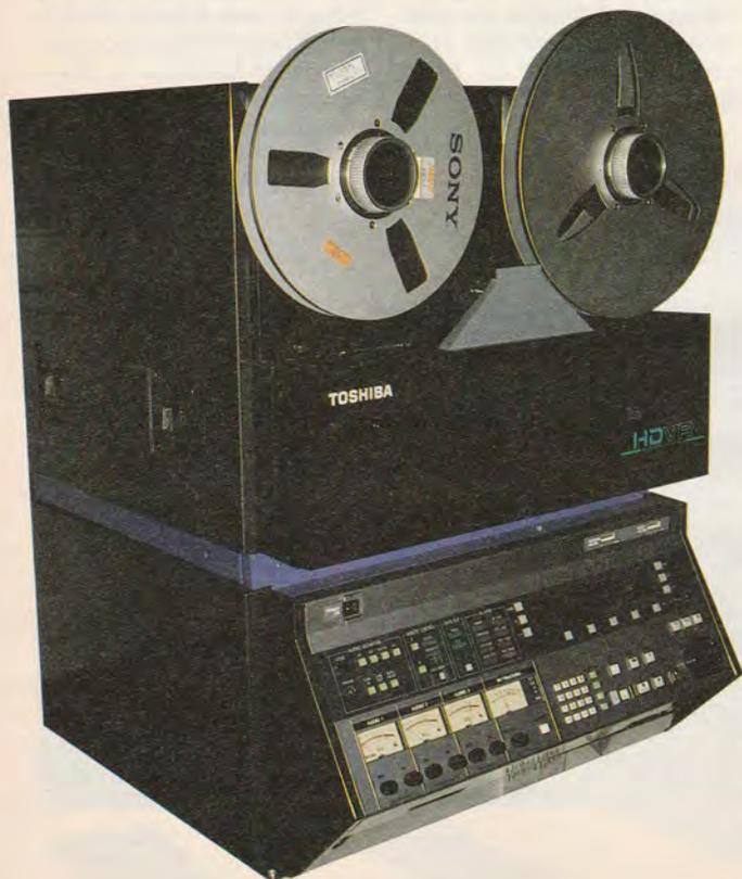
Photo 2. – Magnétoscope Toshiba mis en œuvre avec le système « MUSE » (TVHD).
