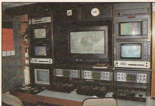
Photo 6. – Une partie de l'équipement du car de reportage HDVS Sony avec, en particulier, ses écrans de contrôle des images et des signaux.
