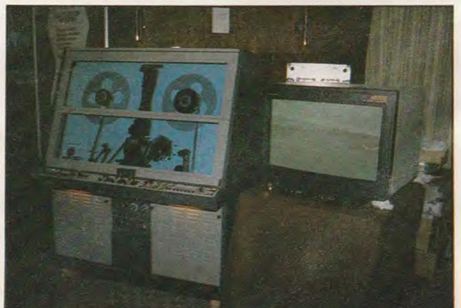
Photo 5. - Télécinéma Rank Cintel TVHD avec moniteur de contrôle SONY à diagonale de 70 cm.
