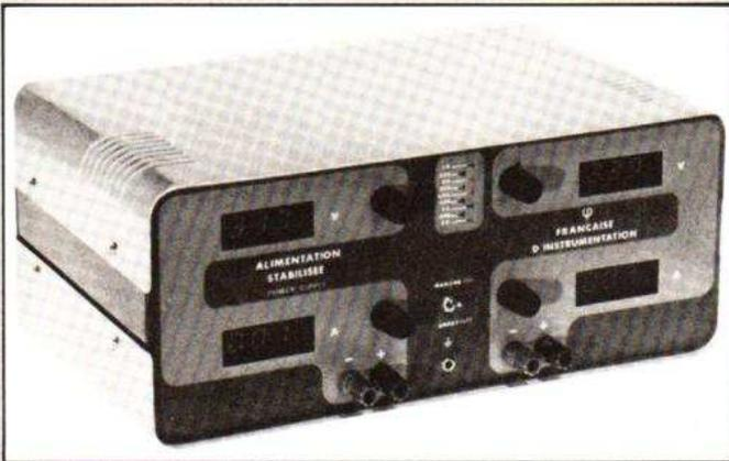
Cette série comprend des alimentations simples (ABT) 0-20 V, 0-30 V, 0-40 V, 0-60 V avec des courants réglables de 0 à 1 A, 2 A, 3 A, 5 A suivant les modèles, et des alimentations doubles (ABTD) 2 x 20 V, 2 x 30 V, 2 x 40 V et 2 x 60 V avec des courants réglables de 0 à 1 A, 2 A ou 3 A.
