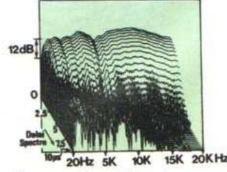
Diagramme énergie/temps/fréquence (3D d'amortissement)
