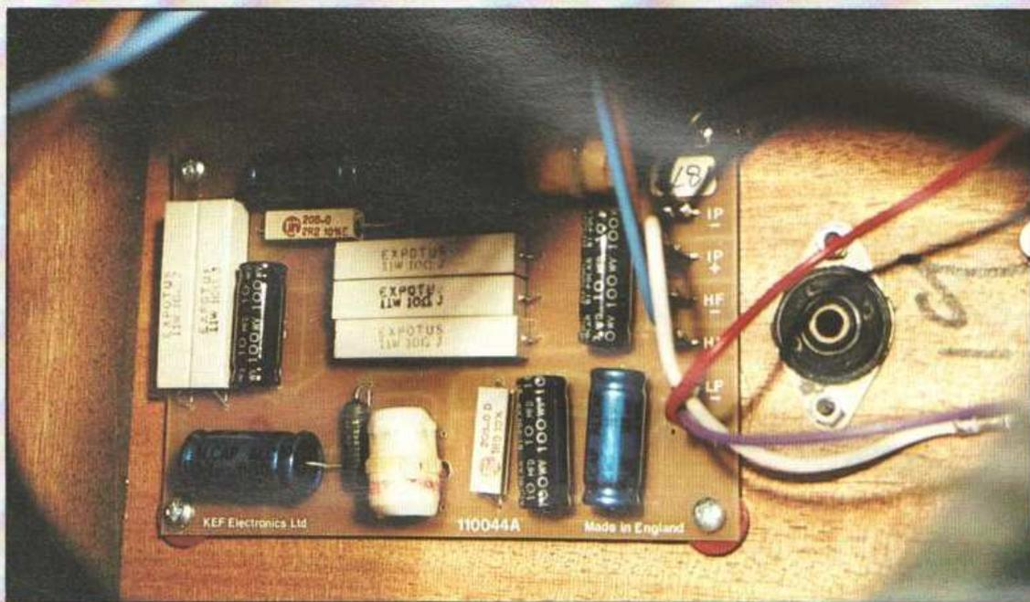
La partie passive du filtre de la Kef met en jeu des éléments de régularisation d'impédance.
