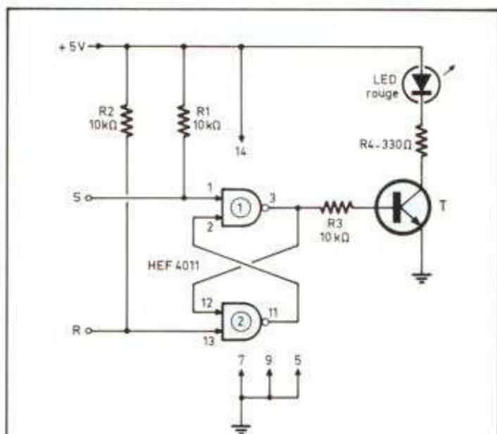
Fig. 23. - On peut réaliser un bistable à deux commandes (nommé « R-S ») avec deux portes « NAND ». Le groupe de  $R_3$ ,  $T$ ,  $R_4$  et la LED constitue ce que l'on nomme un « témoin logique », permettant de connaître l'état du bistable.
