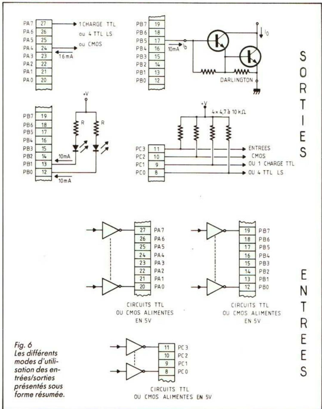
Fig. 6 Les différents modes d'utilisation des entrées/sorties présentés sous forme résumée.
