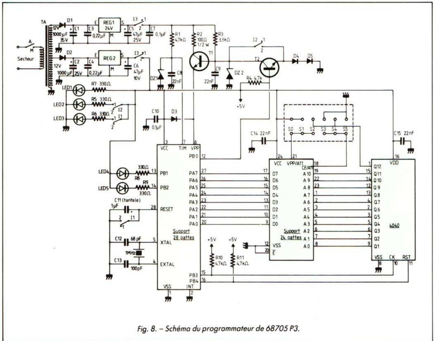
Fig. 8. - Schéma du programmeur de 68705 P3.
