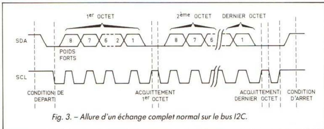
Fig. 3. - Allure d'un échange complet normal sur le bus I2C.
