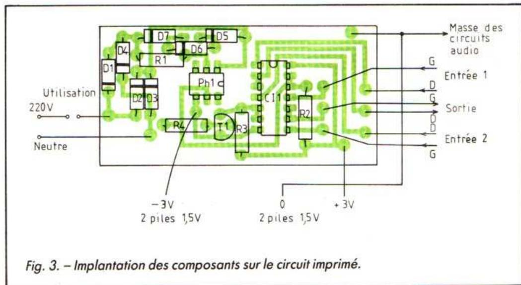
Fig. 3. - Implantation des composants sur le circuit imprimé.
