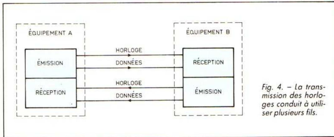
Fig. 4. - La transmission des horloges conduit à utiliser plusieurs fils.
