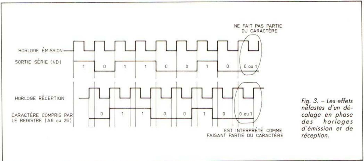
Fig. 3. - Les effets néfastes d'un décalage en phase des horloges d'émission et de réception.
