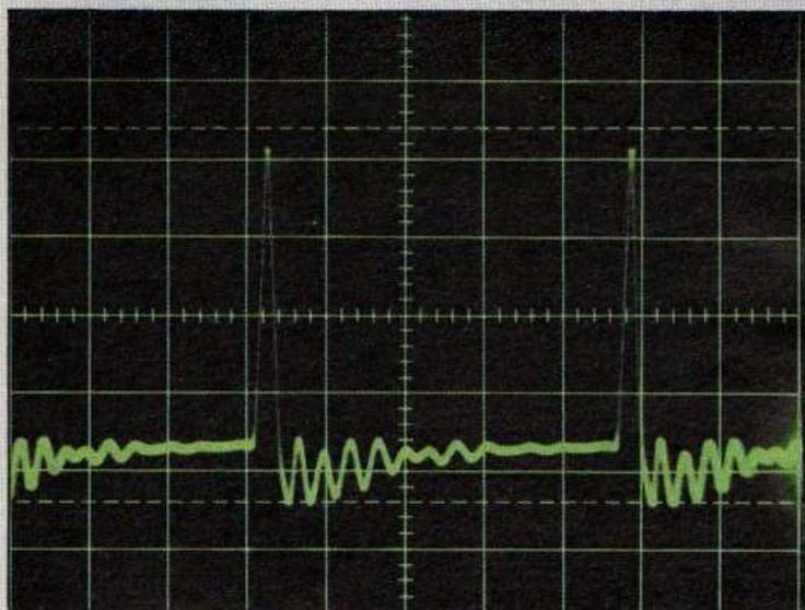
L'extension du balayage (X5) conduit à une vitesse apparente de 100 ns/division. Comparer avec l'oscillogramme B.
