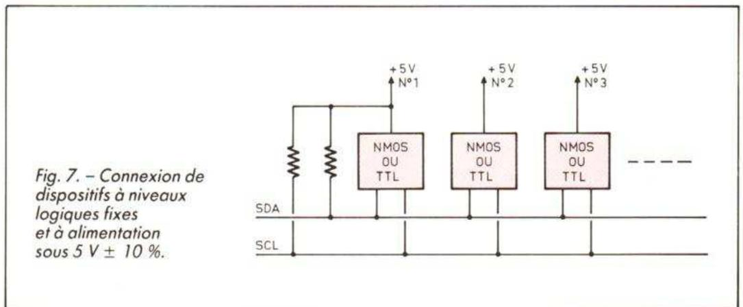
Fig. 7. - Connexion de dispositifs à niveaux logiques fixes et à alimentation sous  $5\text{ V} \pm 10\%$ .
