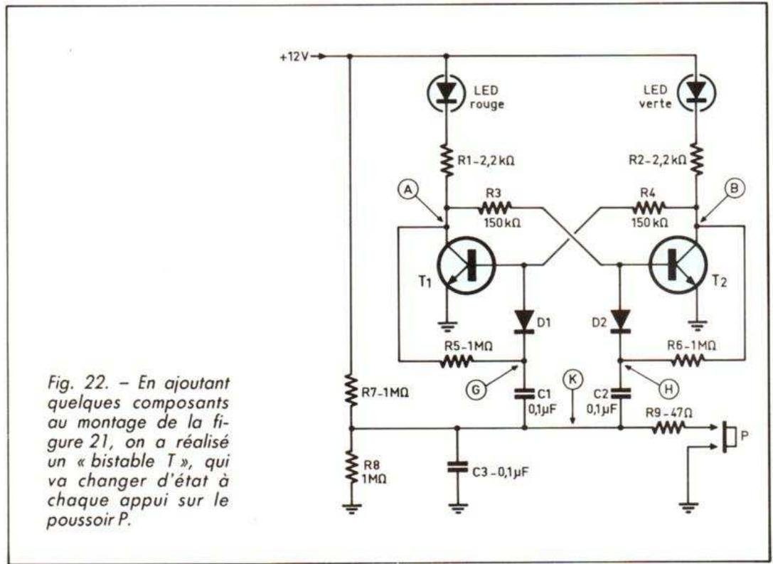
Fig. 22. — En ajoutant quelques composants au montage de la figure 21, on a réalisé un « bistable T », qui va changer d'état à chaque appui sur le poussoir P.
