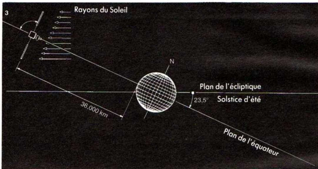
Fig. 3. - Les éclipses ont lieu lorsque l'angle formé par le plan de l'écliptique (plan de la course de la Terre autour du Soleil) et le plan équatorial varie entre  $0^\circ$  et  $8^\circ$  (doc. MBB - ERNO - TV SAT).
