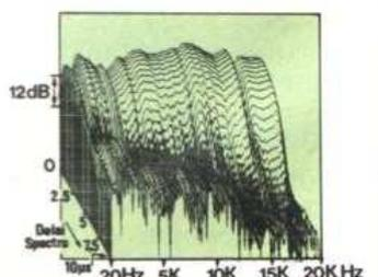
Diagramme énergie/temps/fréquence (3D d'amortissement)
