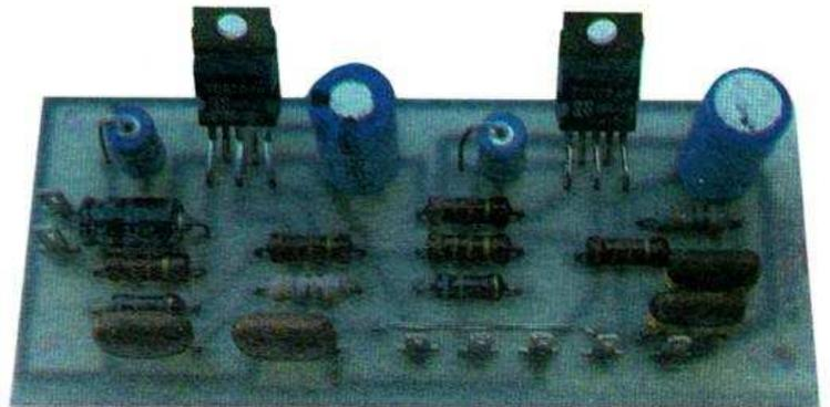
plage de fréquence 40 Hz-15 kHz et de 0,1 à 10 W de puissance de sortie. Bien des amplis conventionnels sont loin de pouvoir en faire autant.
