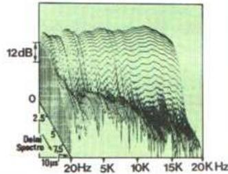
Diagramme énergie/temps/fréquence (3D d'amortissement)
