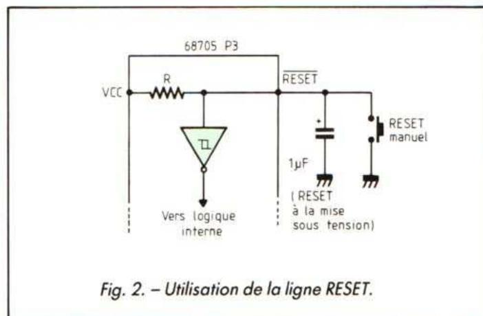
Fig. 2. – Utilisation de la ligne RESET.
