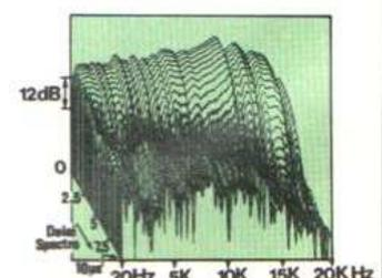
Diagramme énergie/temps/fréquence (3D d'amortissement)
