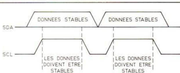
Fig. 2. - Principe fondamental du transfert de données sur le bus I2C.
