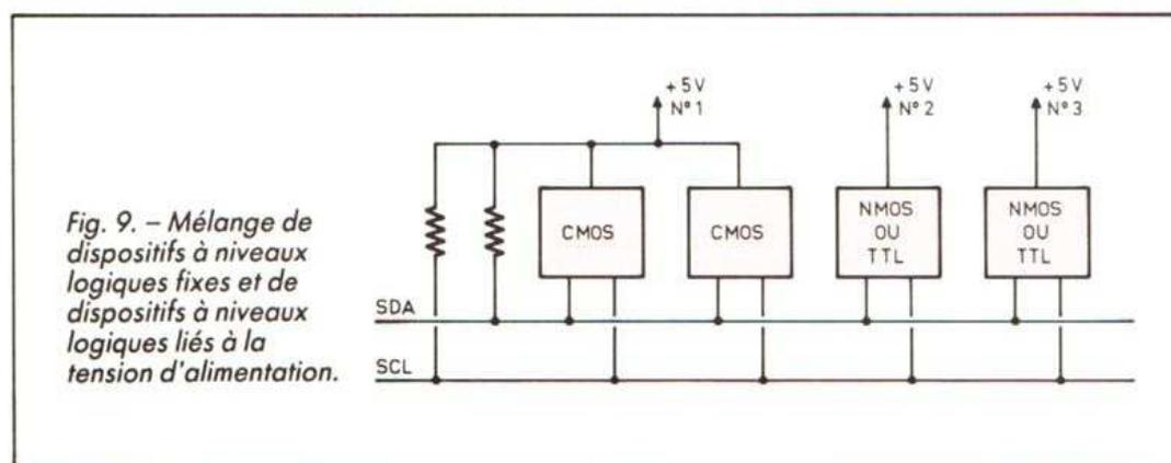
Fig. 9. - Mélange de dispositifs à niveaux logiques fixes et de dispositifs à niveaux logiques liés à la tension d'alimentation.
