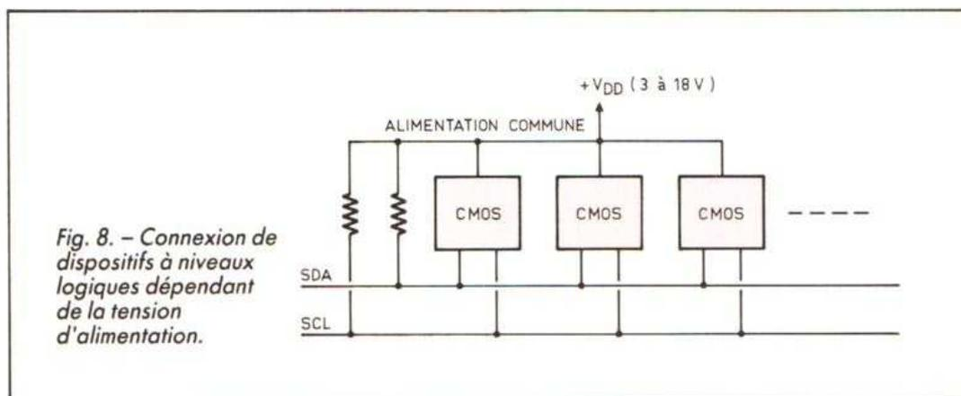
Fig. 8. - Connexion de dispositifs à niveaux logiques dépendant de la tension d'alimentation.
