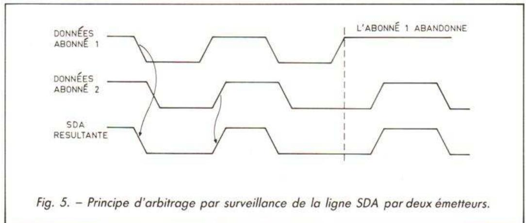
Fig. 5. - Principe d'arbitrage par surveillance de la ligne SDA par deux émetteurs.
