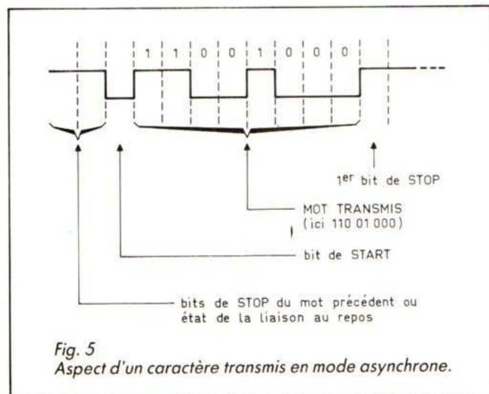
Fig. 5 Aspect d'un caractère transmis en mode asynchrone.
