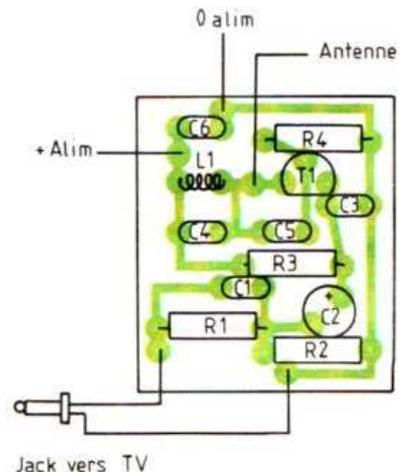
Fig. 3. - Implantation des composants sur le circuit.
