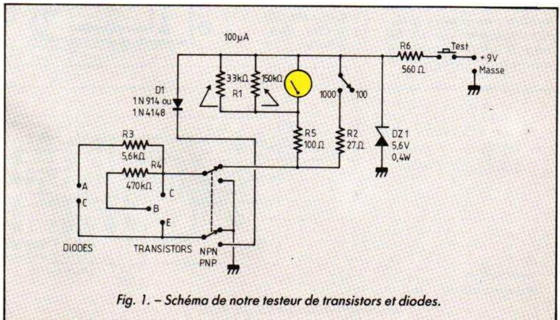
Fig. 1. - Schéma de notre testeur de transistors et diodes.
