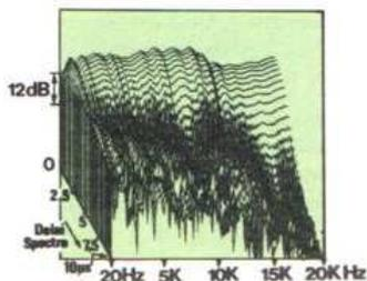
Diagramme énergie/temps/fréquence (3D d'amortissement)
