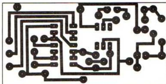
Fig. 2. - Le circuit imprimé (échelle 1/1).
