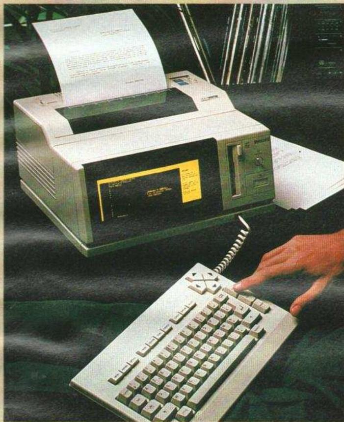
Elle est donc transportable et ne requiert aucune installation particulière. Une fois le fil branché et la machine allumée, il n'y a plus qu'à suivre les instructions. La Vidéowriter écrit, modifie, supprime, remplace, copie, déplace, corrige - même les fautes d'orthographe - imprime, met en page... le tout en six langues. Elle comprend, pour moins de six mille francs :
