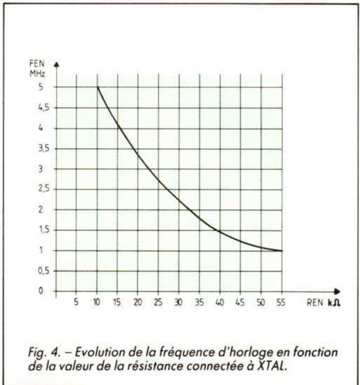
l'heure par exemple), un quartz peut être utilisé. Toute fréquence comprise entre 400 kHz et 4,2 MHz peut être employée, la valeur la plus courante étant 4 MHz en raison du faible coût des quartz à cette fréquence. Dans ce cas, l'horloge interne a la stabilité du quartz utilisé.
