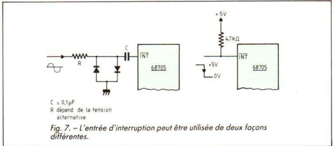
certaines opérations, il n'est pas nécessaire de faire un quelconque câblage sur cette patte, le rebouclage est possible à l'intérieur même du circuit.
