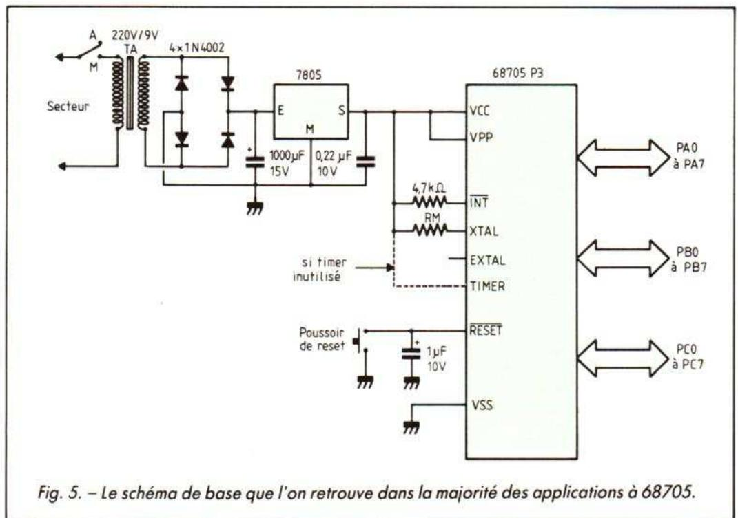
Fig. 5. - Le schéma de base que l'on retrouve dans la majorité des applications à 68705.
