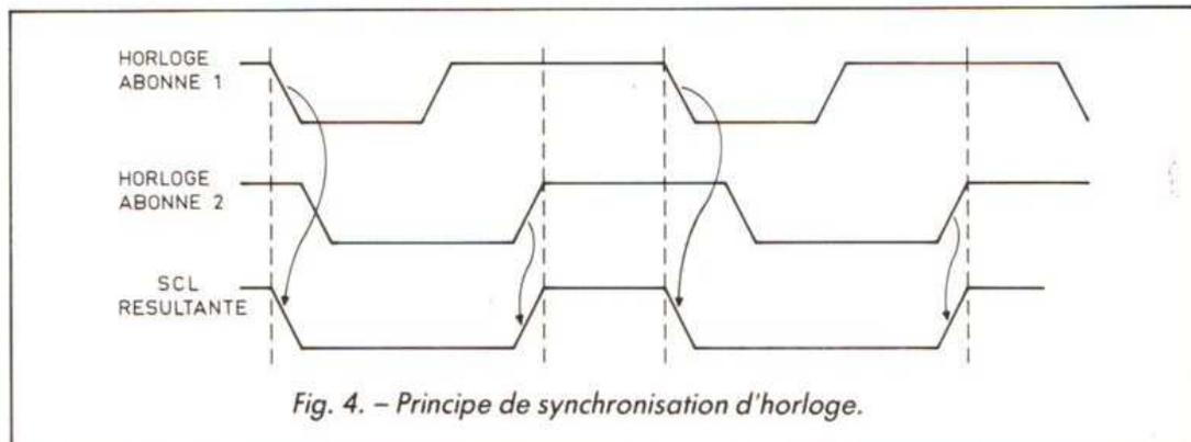
Fig. 4. - Principe de synchronisation d'horloge.
