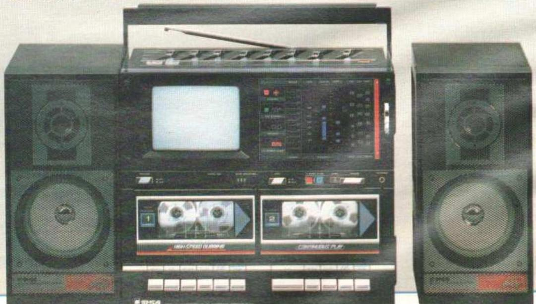
Les enceintes deux voies sont détachables. Plus à l'aise au Salon, le MCD 570 est une chaîne compacte composée d'un ampli, d'un tuner, d'un magnétophone à double platine cassette, d'une table de lecture disques et d'un lecteur de disque compact. Le tout délivre 40 W à deux enceintes acoustiques deux voies.
