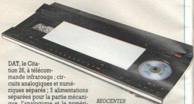
DAT, le Citation 26, à télécommande infrarouge ; circuits analogiques et numériques séparés ; 3 alimentations séparées pour la partie mécanique, l'analogique et le numérique ; suréchantillonnage quadruple, convertisseurs 16 bits séparés pour chaque canal, etc.
