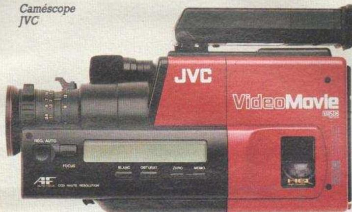
C'est le GR 45S, avec un nouveau capteur CCD à haute résolution, un obturateur électronique à deux vitesses (1/50<sup>e</sup> et 1/1000<sup>e</sup> de seconde), un système de commande de montage, l'enregistrement de la date et de l'heure.
