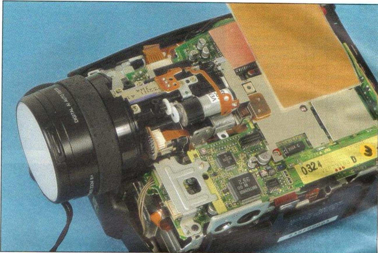
Une bague caoutchoutée commande la mise au point manuelle ; sous le micro, une zone capte les rayons infrarouges et aide au réglage de l'équilibre des couleurs.
