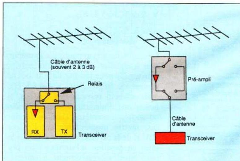
**A gauche : station VHF standard, à droite station VHF performante.**
