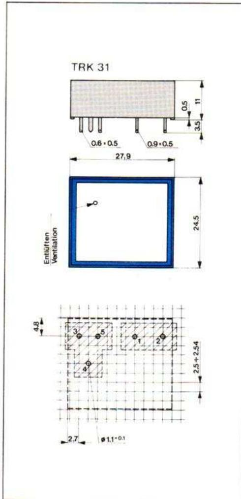
Fig. 2. - Caractéristiques mécaniques des relais TRK 31 XX.
