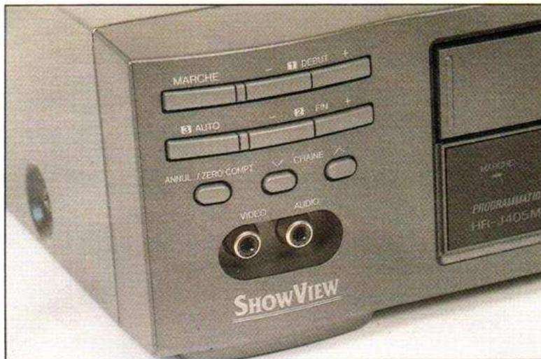
Deux prises RCA en face avant, directement accessibles aux signaux vidéo PAL ou SECAM venus d'un caméscope... Ici, on peut programmer un enregistrement dans les prochaines 24 heures.
