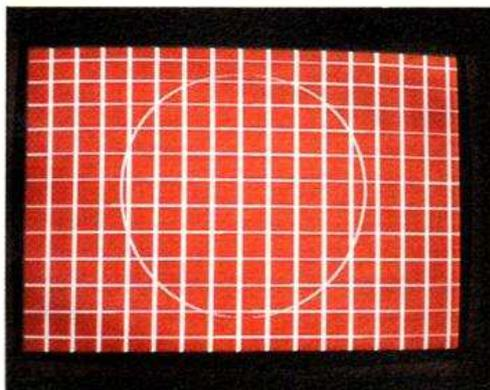
Mire quadrillage et cercle, facilitant le centrage de ce dernier pendant la phase de réglage.
