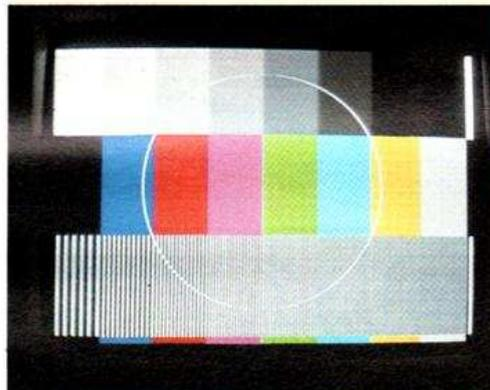
Mire composée : échelle des gris, barres de couleur, salves, cercle. Remarquer les points d'intersection du cercle avec les coins (bleu, jaune) du signal barre de couleurs. C'est cette figure qu'il faut rechercher durant les réglages de la partie « cercle ».
