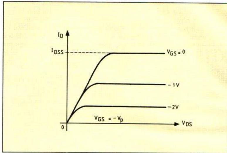
Fig. 4 Réseau de caractéristiques d'un transistor FET.
