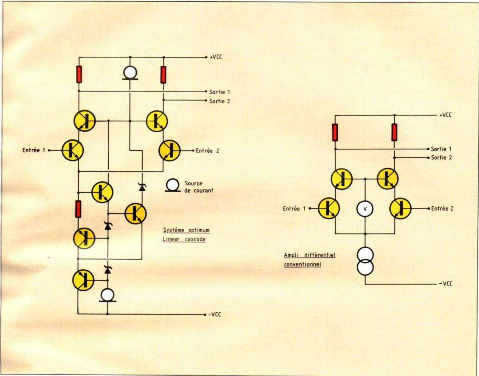
Fig. 1. - Comparaison des structures d'ampli différentiel.
