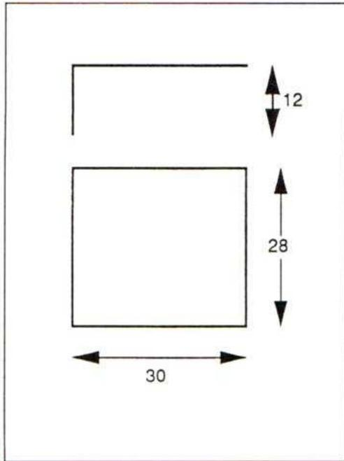
Fig. 5. - Blindage en tôle étamée épaisseur 0,5 mm.
