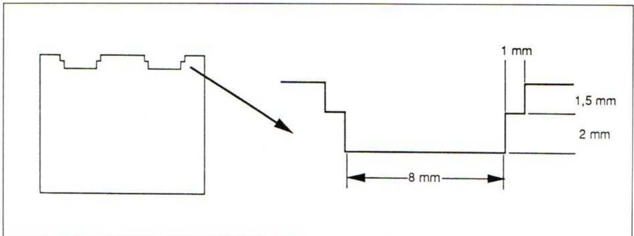
Fig. 9. - Découpe du passage des prises à la lime plate.
