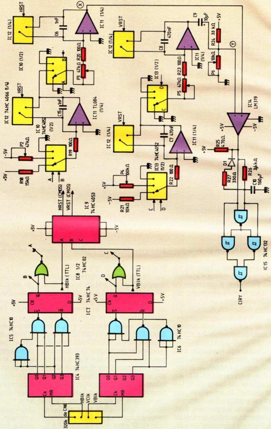
Schéma de principe de la partie générateur du signal « cercle ».
