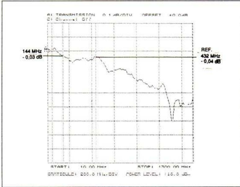
**Fig. 10. – Pertes de passage direct ; relais ISKRA TRK 3113.**
