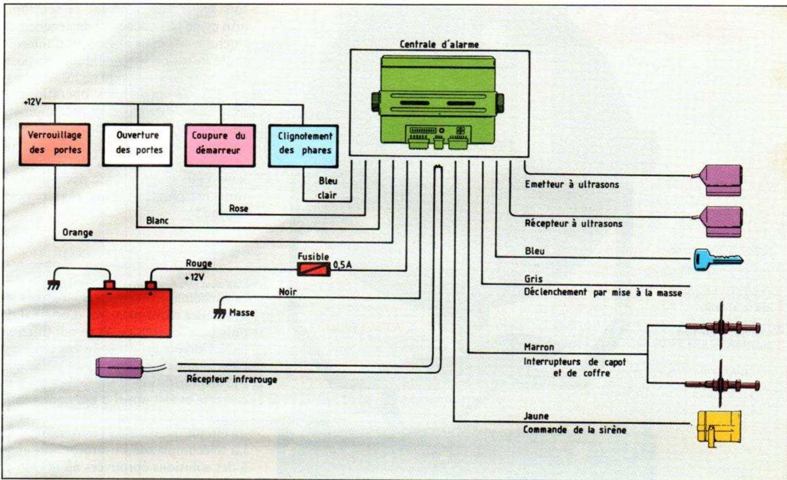
Fig. 1. - Synoptique de câblage général de l'alarme CA 08.
