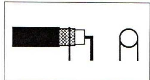
Fig. 8. - Accostage du coaxial sur le circuit avec une boucle de fil Ø 0,6 mm.
