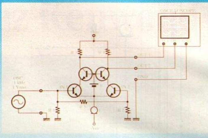
Méthode de mesure du taux de réjection en mode commun utilisée par Kenwood. L'oscilloscope (Kenwood) calcule la différence de tension sur les collecteurs de l'ampli différentiel.
