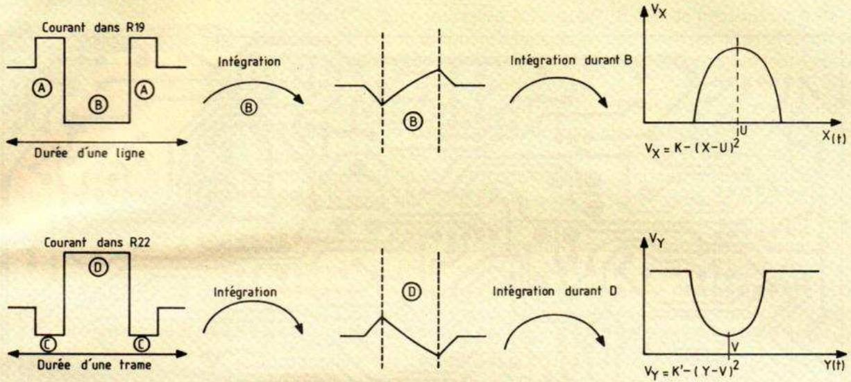
Fig. 3. - Principe simplifié de la génération de sections de paraboles synchronisées sur les lignes et les trames.
