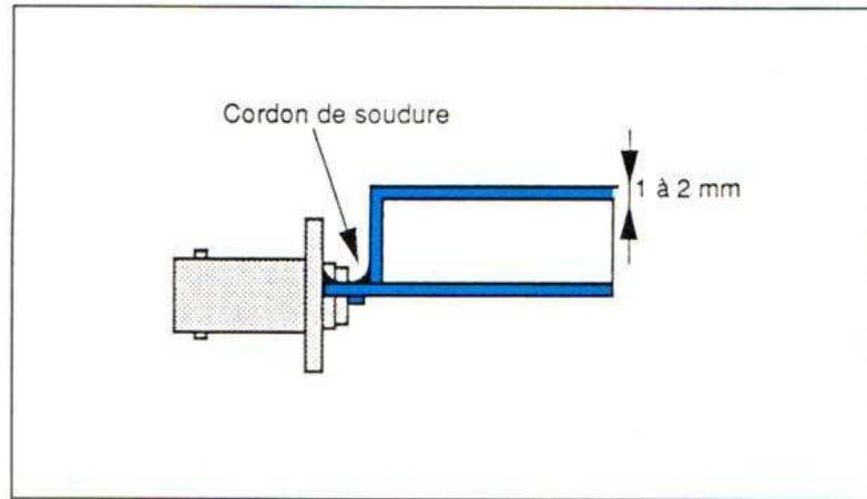
Fig. 7. - Suite des opérations à effectuer pour préparer les prises BNC.
