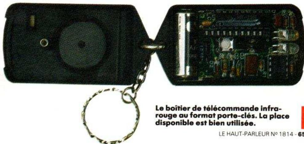
Le boîtier de télécommande infrarouge au format porte-clés. La place disponible est bien utilisée.
