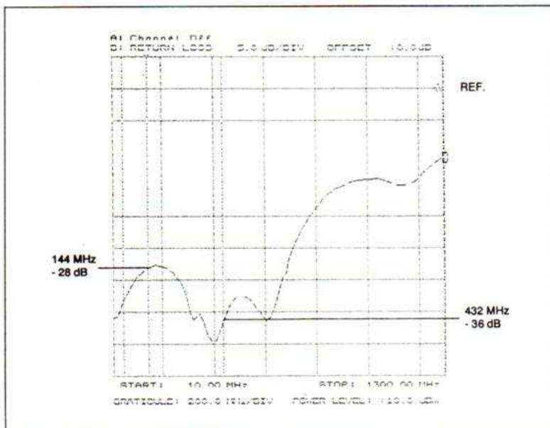
**Fig. 12. – Adaptation sur 50 Ω ; relais ISKRA TRK 3113.**
