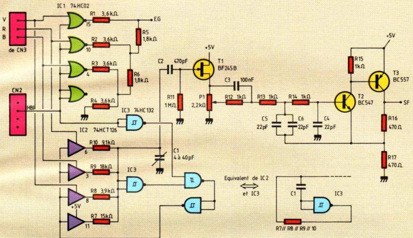
Fig. 1. - Schéma de principe de la partie générateur de signaux « échelle de gris » et « salves ».
