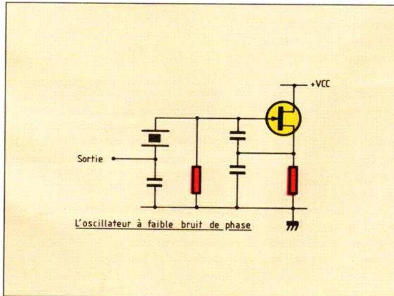
Fig. 2 Schéma simplifié de l'oscillateur à faible bruit de phase utilisé comme référence d'horloge dans les lecteurs CD.
