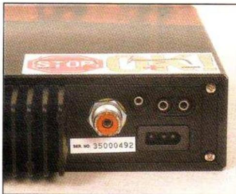
**La prise d'alimentation ne peut pas se brancher à l'envers ; de toute façon, l'appareil est protégé contre les inversions de polarité. Les jacks sont là pour un S-mètre et des haut-parleurs externes. Notez la taille des ailettes du radiateur.**
