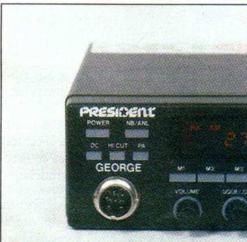
La prise micro est assez classique, elle se vissera sur l'embase, les six contacts sont nécessaires pour la sélection des canaux.
