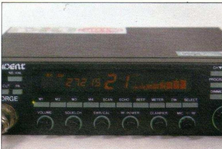
L'indicateur à cristaux liquides donne la fréquence d'émission ainsi que le numéro du canal ; sur la droite, un indicateur de niveau, ici 5-mètre, indication du niveau en réception. Une ligne de touches lumineuses donne accès à des stations, des modes différents.
