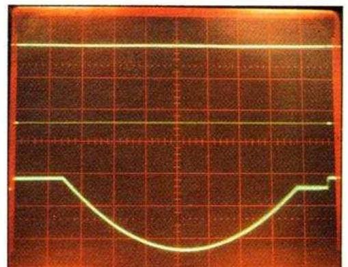
En haut, la synchro composite observée durant une trame (2 V/div.). En bas, la section de parabole inversée.
