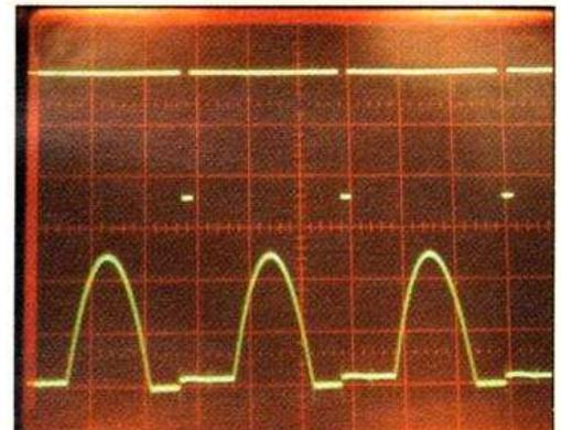
Oscillogramme. En haut, la synchro « lignes » (2 V/div.). En bas, la sortie du deuxième intégrateur lignes (borne 7 de IC11) (0,5 V/div.) montrant les sections de paraboles (20 µs/div.).
