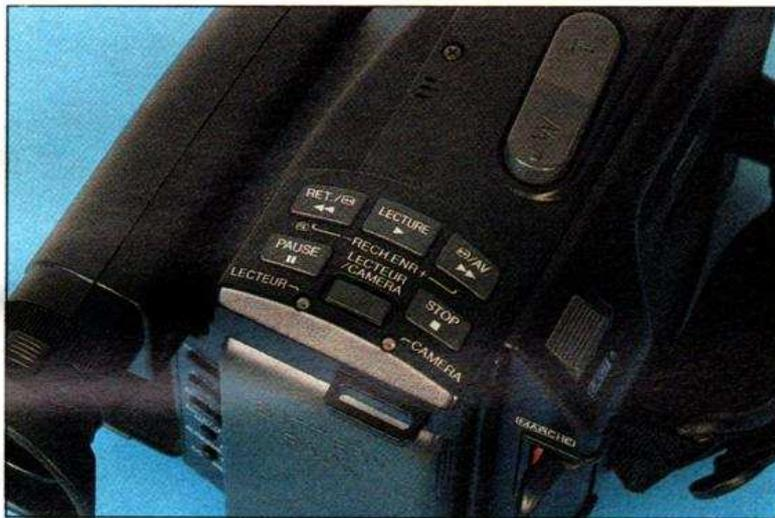
Placé à la partie supérieure, ce clavier est spécialisé dans la commande du magnétophone. La touche centrale, encadrée de deux voyants, sélectionne le mode magnétophone ou camescope.
