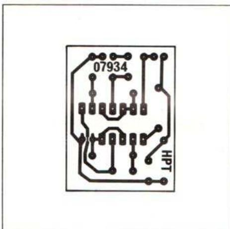
**Fig. 2. -** Circuit imprimé, vu côté cuivre, échelle 1.
