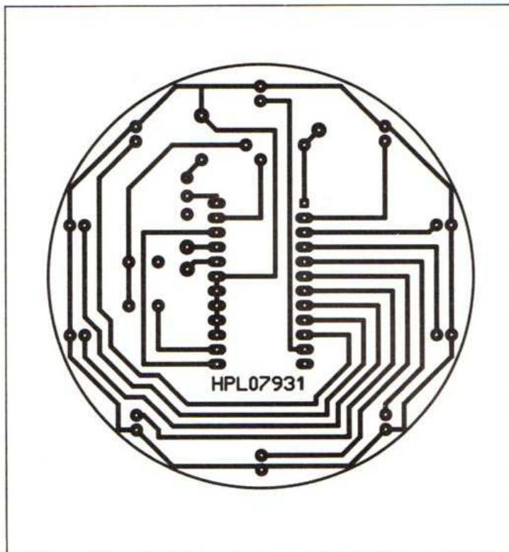
Fig. 2. - Circuit imprimé, vu côté cuivre, échelle 1.
