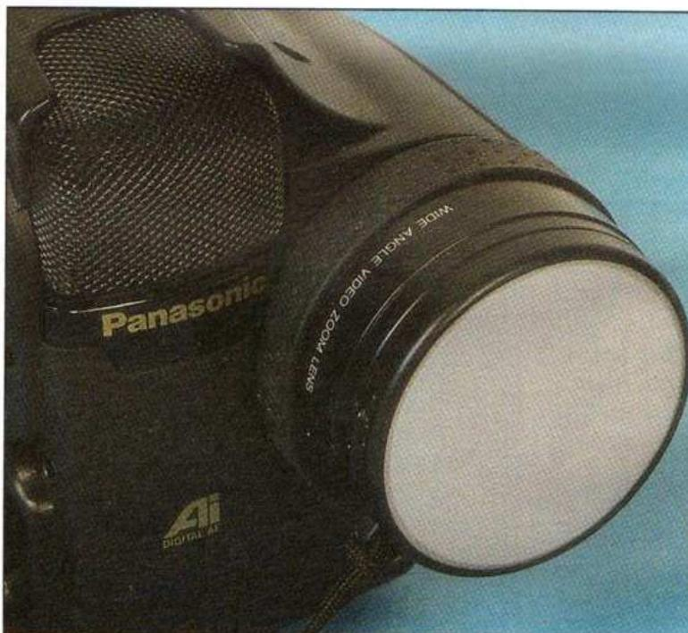
Le camscope est monophonique et enregistre le son sur une piste longitudinale avec la qualité que l'on sait ; nous n'avons pas ici d'enregistrement HiFi et stéréophonique. Le micro est situé à côté de l'objectif, une place classique, et si vous avez besoin d'une qualité de
