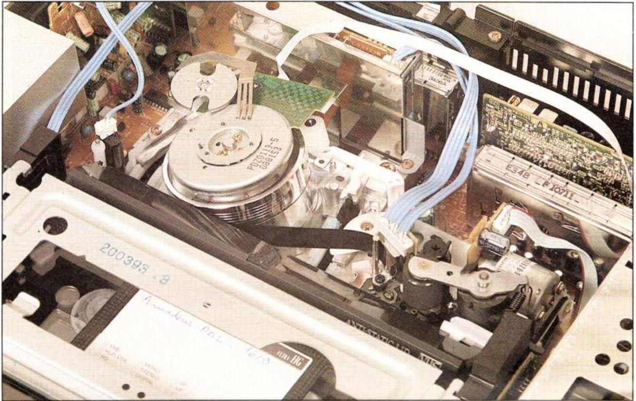
Le moteur d'entraînement du tambour vidéo est installé au-dessus de ce dernier. Derrière, un petit balai se prépare au nettoyage lorsque la cassette sera déchargée.
