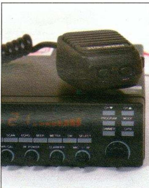
Un rotacteur, deux touches de canal sur l'appareil, plus deux touches sur le micro : trois façons d'accéder aux canaux, avec des variantes...
