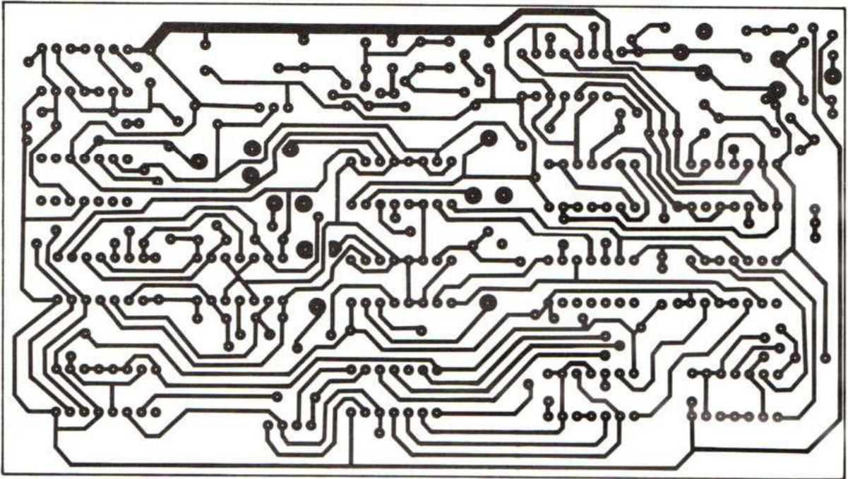
Fig. 4. - Circuit imprimé côté cuivre du générateur de signaux.
