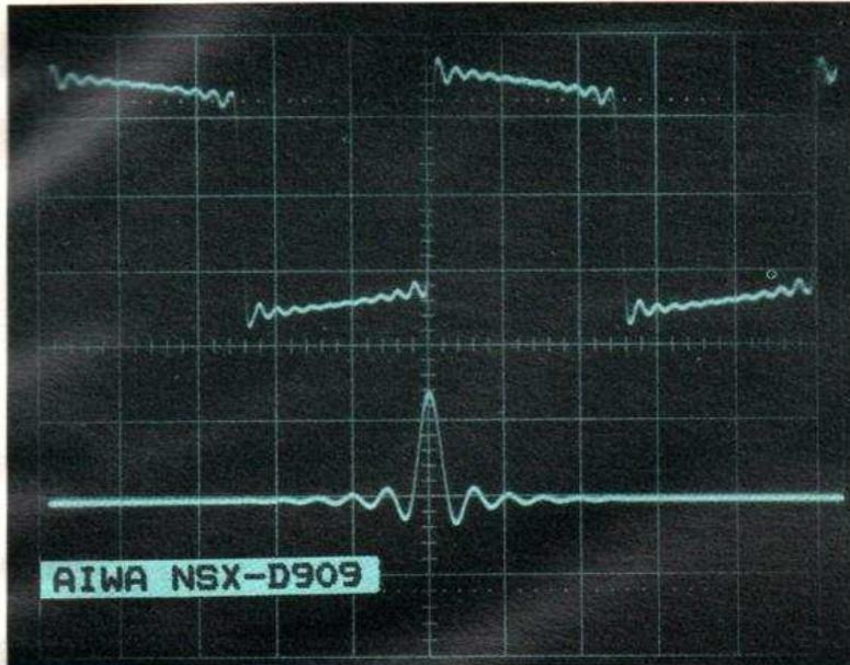
Réponse du lecteur de CD et de l'amplificateur aux signaux carrés. Le traitement est tout numérique et la réponse dans le grave se retrouve sur les parties normales horizontales du tracé. L'échelle verticale est de 10 V/div., l'horizontale de 200  $\mu$ s pour les signaux carrés et 100 pour les impulsions.
