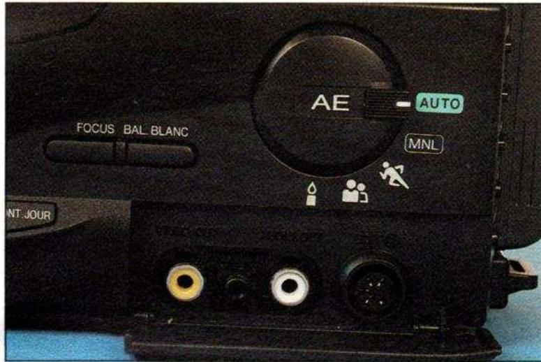
Un rotacteur permet de choisir un programme d'exposition ou un mode manuel, les deux petites touches sélectionnant le paramètre manuel. Dans le bas : connectique pour la sortie et aussi le raccordement à une table de montage.
