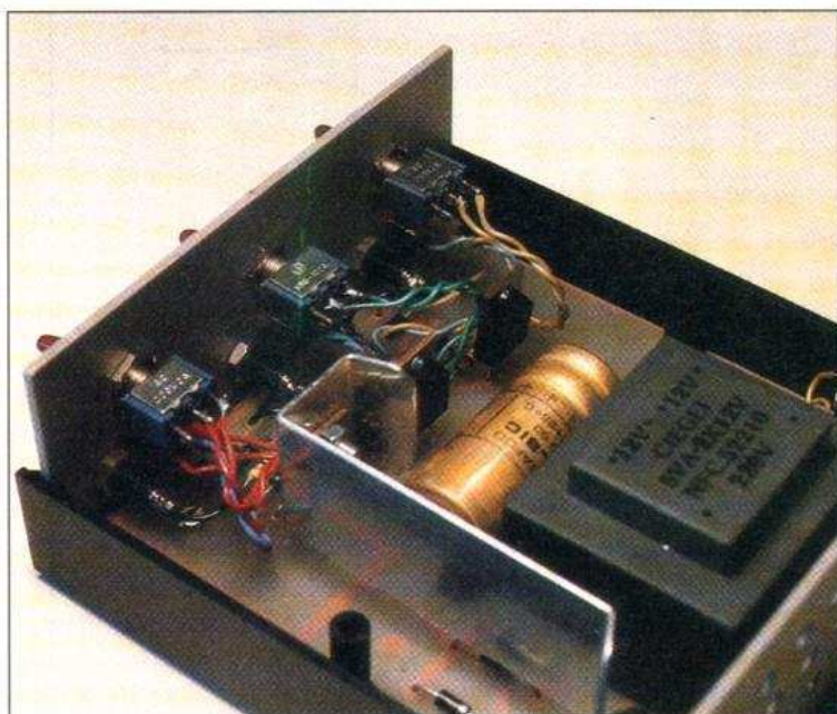
Vue intérieure du chargeur. Remarquer le radiateur du LM317/100 mA, en tôle alu 10/10 formée.
