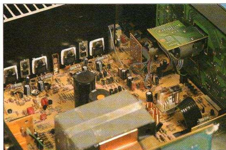
Transistors de puissance en boîtier plastique, potentiomètre motorisé, transformateur à ceinture de cuivre : non, l'ampli n'est pas japonais !
