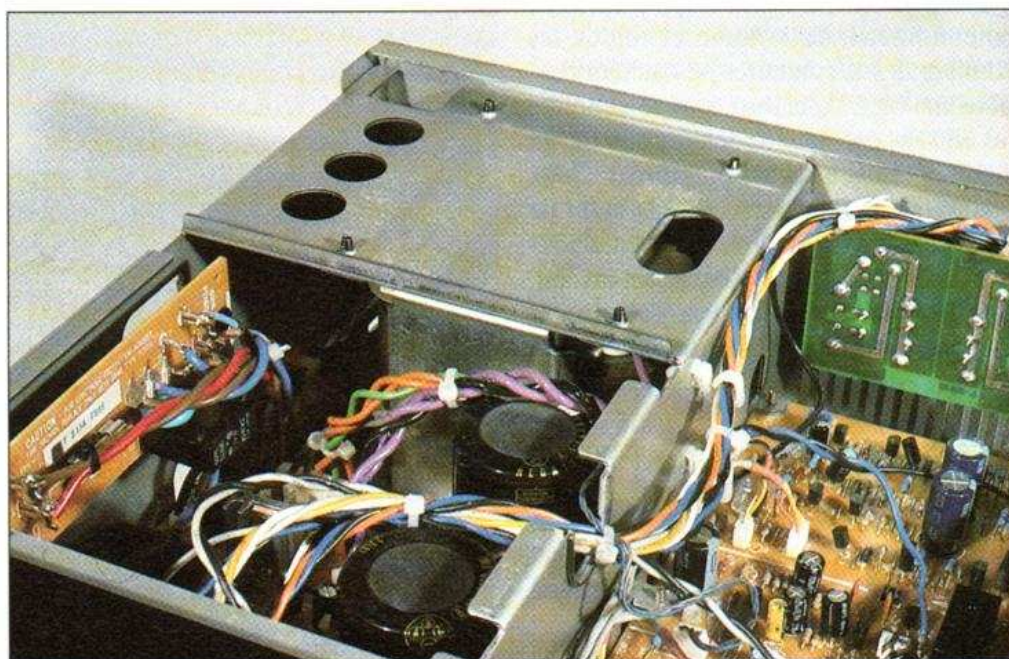
Sansui : une alimentation installée sur un châssis de tôle très épaisse.
