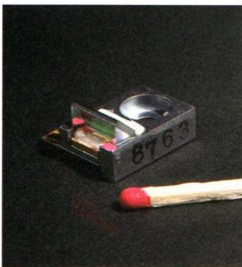
Gros plan sur le générateur de lumière, les diodes sont placées sous le prisme, la lumière sort perpendiculairement à la surface verticale.
