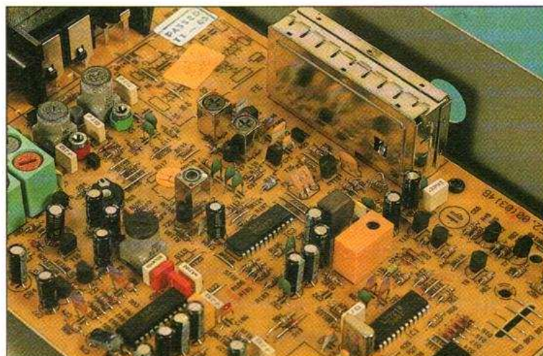
Le tuner : des circuits de la famille Sanyo, dont un synthétiseur de fréquence, une tête RF enfermée dans un blindage.
