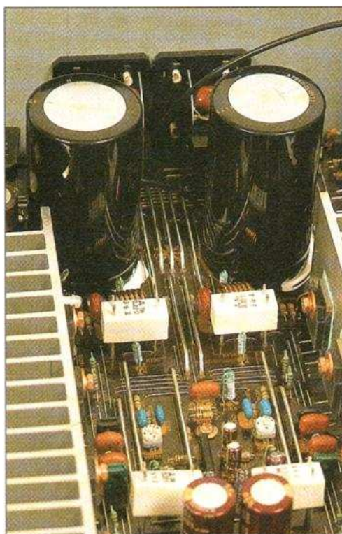
Yamaha installe des barres de cuivre pour réduire l'impédance des conducteurs du circuit imprimé.
