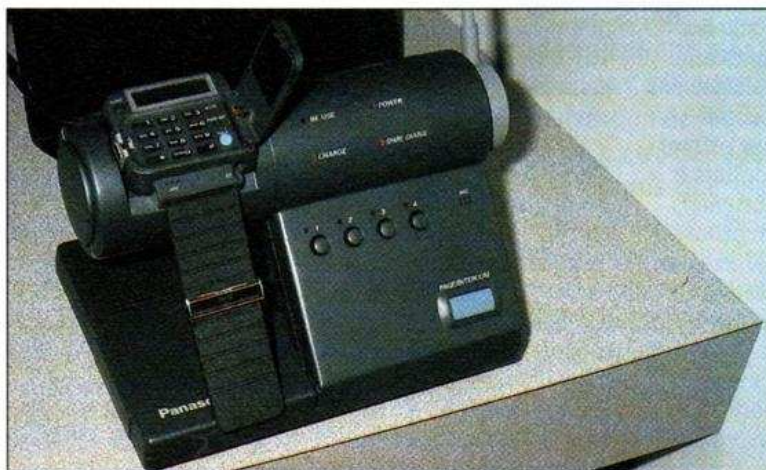
Cette montre est en fait un radiotéléphone dont le couvercle sert d'écouteur.
