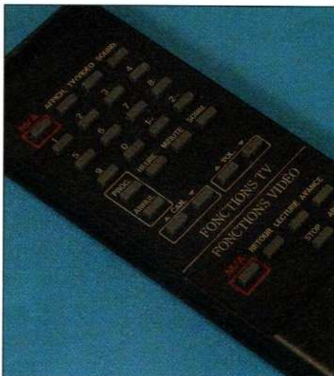
La télécommande est double : en haut, on commande le téléviseur, en bas, le lecteur.
