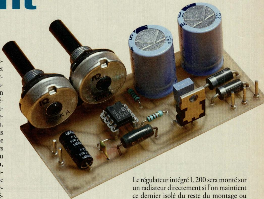
Le régulateur intégré L 200 sera monté sur un radiateur directement si l'on maintient ce dernier isolé du reste du montage ou avec les classiques accessoires d'isolement dans le cas contraire. N'oubliez pas la traditionnelle graisse aux silicones pour améliorer la conduction thermique.
