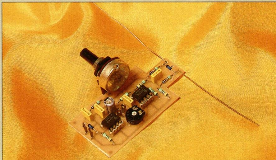
ties des circuits intégrés IC<sub>1</sub> et IC<sub>2</sub>. Le potentiomètre P<sub>1</sub> permet d'ajuster le montage à la sensibilité du galvanomètre utilisé tandis que P<sub>2</sub> est le réglage de zéro. L'alimentation de l'ensemble est confiée à une pile de 9 V pour laquelle la consommation reste très faible.
