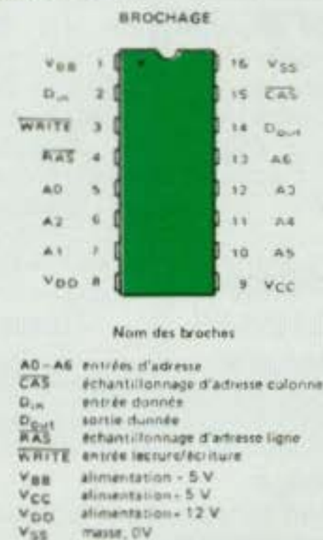
Fig. 3. Brochage et architecture d'une mémoire dynamique 4116.
