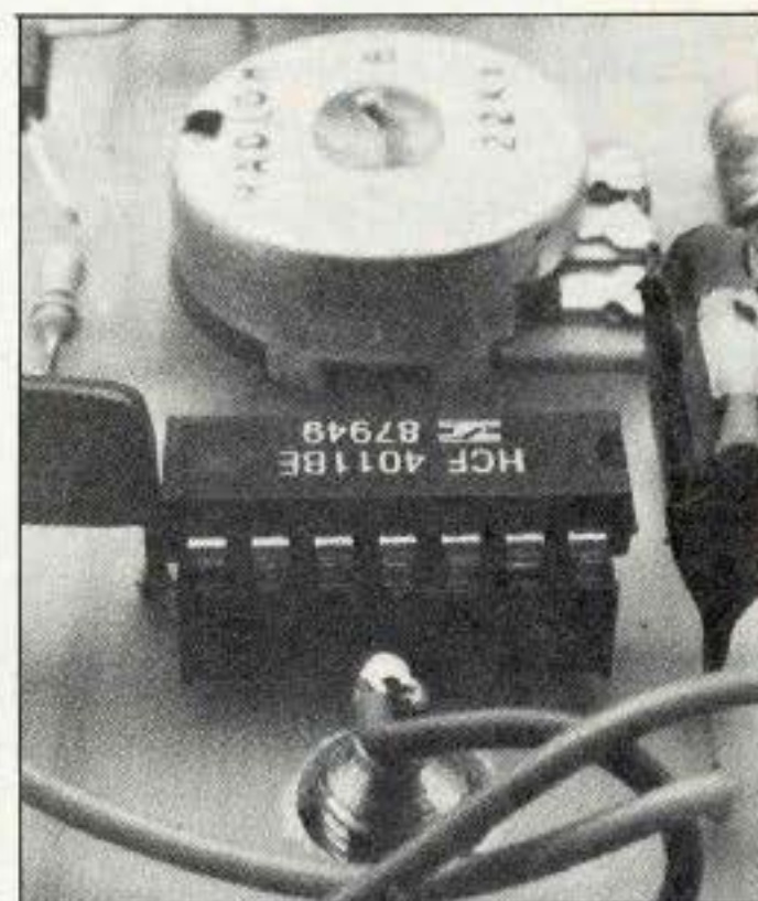
Le circuit intégré CD 4011 délivre un signal carré à partir de deux portes NAND.
