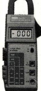
Il est évident que peu de techniciens ont besoin de mesurer des courants de 400 A. Cet appareil a une vocation industrielle et sa conception mécanique est faite en conséquence.
