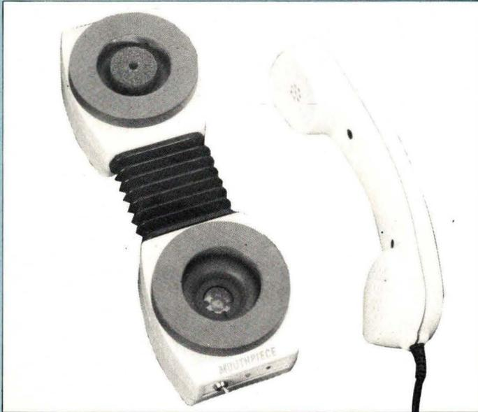
Fig. 7 : Interface acoustique pour Modem (Doc CDT)
