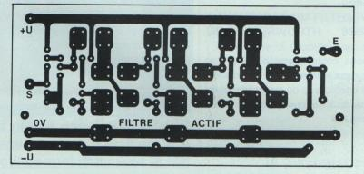
Figure 5 : un unique circuit imprimé pour les 2 filtres
