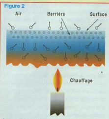
Lorsque l'on chauffe le métal, l'agitation moléculaire est de plus en plus importante, un grand nombre d'électrons est libéré, ces électrons s'accumulent à la surface du métal, repoussant les nouveaux venus, c'est la barrière de surface.
