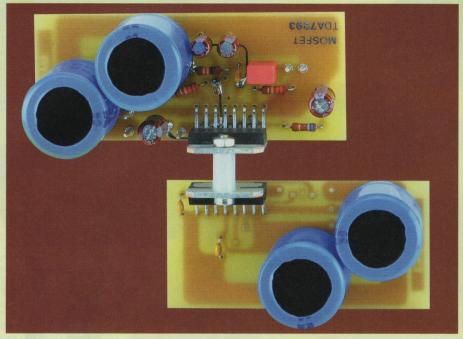
Durant six années, nous nous sommes «amusés» avec le TDA7294, un circuit intégré à 15 broches capable de fournir allègrement une puissance de 70 Weff dans une charge de 8  $\Omega$ , avec seulement 0,5 % de taux de distorsion. Que va nous apporter le TDA7293 par rapport à son ancêtre ? Au niveau du boîtier, aucune différence. Nous avons toujours en main un «Multiwatt 15» avec ses broches disposées en quinconce au pas de 2,54 mm.
