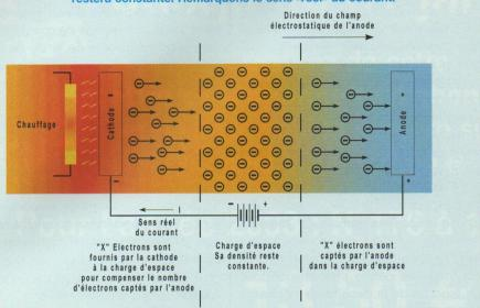
Cette charge d'espace va atteindre un niveau d'équilibre en fonction de la température de la cathode, donc de la tension de chauffage.
