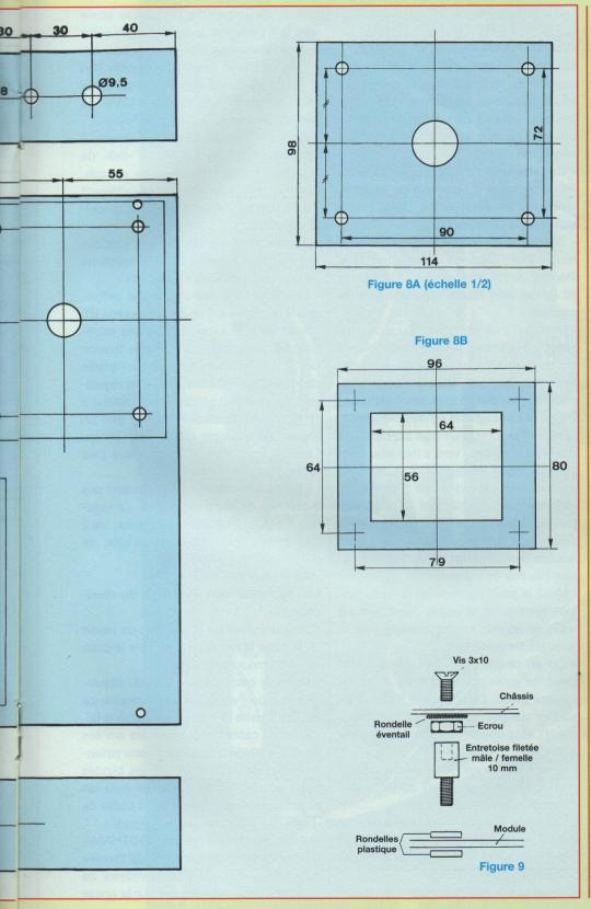
entre les pastilles (7) et (8) du support de gauche puis celle entre les pastilles (2) et (3) de celui de droite. Tracer la ligne horizontale qui détermine les deux autres centres.
