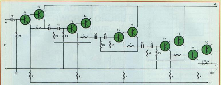
Figure 4 : schéma du filtre passe-haut adopté, tout transistors
