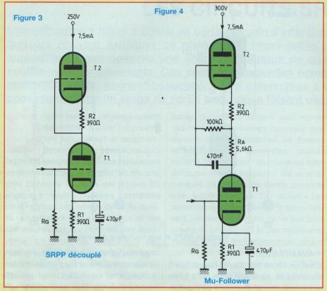
signaux pour le SRPP non découplé, car les équations qui s'y ramènent pourront être adaptées aux autres membres de cette famille (figure 2). Afin d'obtenir l'équation générale, nous allons appeler respectivement  $P_1$ ,  $P_1$  et  $P_2$ ,  $P_2$  les résistances internes et gain en tension des tubes T1 et T2, bien qu'il s'agisse ici d'éléments identiques, et R1 R2 leur résistance de polarisation.
