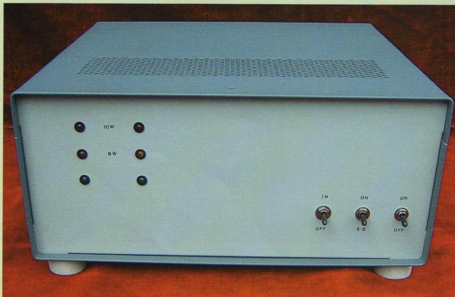
L'amplificateur ici proposé utilise des composants classiques, mais présente un schéma un peu plus complexe que de coutume. Un soin tout particulier a été porté sur la symétrie des circuits d'attaque du Push-Pull, la stabilité du montage ... et la sélection des tubes.
