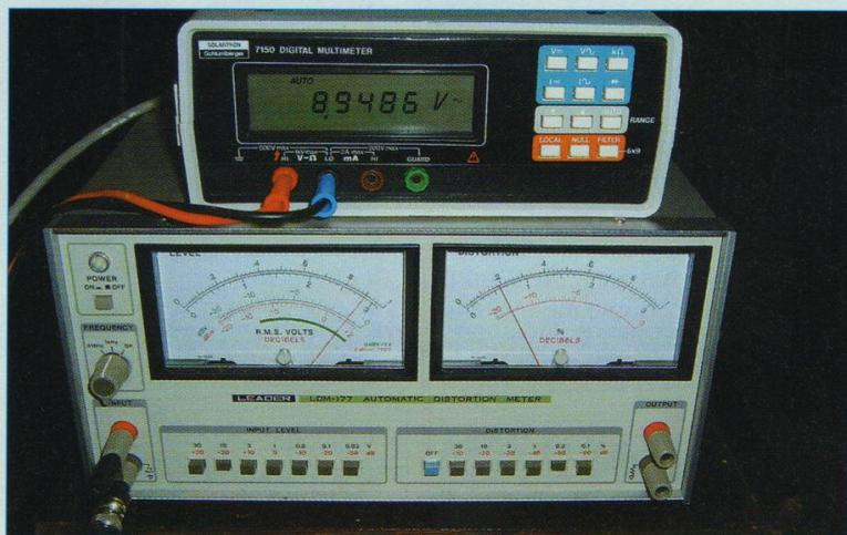
Distorsion à 1 kHz et à 10 W : 0,06 %
