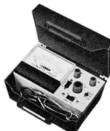
Transistorimètre IT-18 Mesure le gain CC en ou hors circuit Mesure le courant de fuite émetteur-collecteur - Contrôle des diodes - Cadran gradué directement en β et en courant de fuite - Alimentation par piles.
