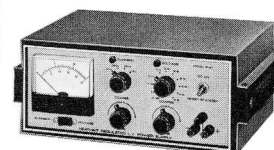
Alimentation Stabilisée Basse Tension IP-27 Tension réglable de 0,5 à 50 volts - Entièrement transistorisée - Limitation de courant - Galvanomètre indiquant la tension ou le courant - Tension de référence par diode Zener.
