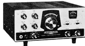
Transceiver Décamétrique 5 bandes HW-100 VFO transistorisé - Bandes 80-10 m - SSB : 180 W PEP - CW - 170 W - Bande supérieure, inférieure ou CW - Calibrateur 100 kHz incorporé.
