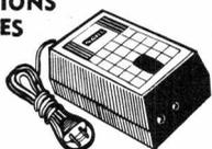
STOLLE 3406. Secteur 110/220 V. Sorties en courant continu stabilisé, commutable de 4-5-6-7-5-9 et 12 V par transistor puissance et diode Zener. Débit 400 mA. Protection secteur (120x75x50). Livré avec câble et fiche.
