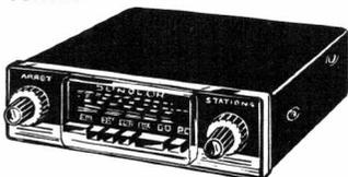
Commutable 6/12 V (9 transistors + 4 diodes), 3 touches pré-réglées en GO + 3 touches PO-GO - Bande FM - Eclairage cadran - 3 possibilités de fixation rapide - HP 12x19 en boîtier - Puissance 3,5 W. Compl. av. antenne G antipar. Net 245,00 - Franco 255,00
