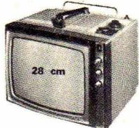
Tube 28 cm. Tous canaux. Fonctionne sur secteur 110/220 V ou sur batteries (batteries rechargeables incorporées en option). PRIX ..... 830,00
