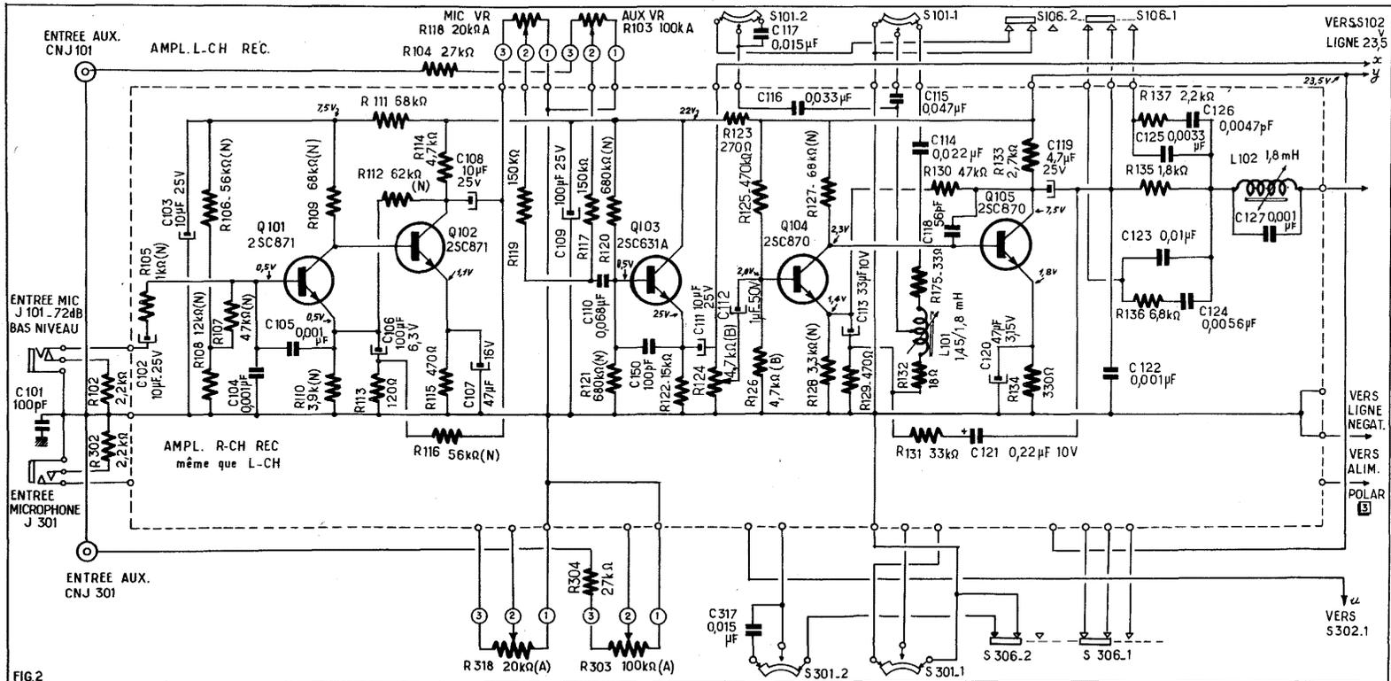
Passons maintenant à la section polarisation. On sait que dans l'enregistrement sur ruban magnétique, on applique aux têtes d'enregistrement, le signal BF à enregistrer et un signal HF de polarisation ayant la même origine que celui d'effacement.
