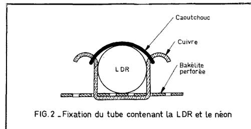
40 mm de long. Le tube est fermé par deux tampons de caoutchouc noir genre joint pour robinet ( $\varnothing$  16). Les fils de sortie sont serrés entre plastique et caoutchouc. Repérer le fil du néon qui va à la grille : c'est l'électrode à mettre au « — ».
