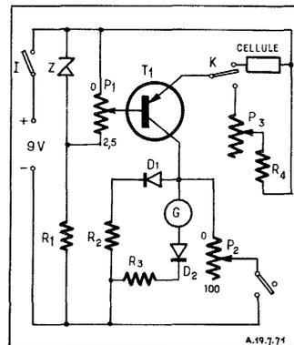
sombre. On lit i. Le contraste est donné par  $\frac{100}{i}$ . On obtient avec G seul (sans R<sub>2</sub>, D<sub>1</sub>, R<sub>3</sub>, D<sub>2</sub>) des valeurs de i comprises entre 4 et 25 μA. Afin d'étaler la lecture on règle R<sub>2</sub> et R<sub>3</sub> de façon que lorsque G affiche 100 μA I<sub>c</sub> = 200 μA G = 65 μA I<sub>c</sub> = 100 μA G = 20 μA I<sub>c</sub> = 20 μA ce qui permet d'obtenir pour i des
