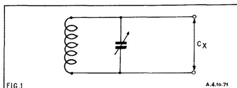
La capacité parasite introduite décale légèrement l'étalonnage du cadran, mais ce n'est pas grave et on peut réaligner le récepteur si on le juge utile.
