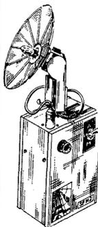
Pour doser et modeler à volonté les ombres et la lumière d'un sujet à photographier. Il comporte un flash magnésique déclenché par une cellule photo-électrique, elle-même impressionnée par le flash principal de l'appareil qui prend la photo. Réflecteur orientable. Possibilité de disposer plusieurs SFM 2. Déclenchement jusqu'à 8 m. Autonome, sans fils de liaison. Possibilité de disposer chaque SFM 2 en tous endroits pour doser à volonté l'éclairage du sujet à photographier.
