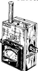
Tachymètre ou compte-tours, permettant de mesurer la vitesse de rotation de moteur, pignon, tout système tournant. Il procède sans liaison mécanique, on présente la cellule photoélectrique que comporte l'appareil devant le moteur et on lit la vitesse de rotation sur un cadran à aiguille, en nombre de tours par minute.
