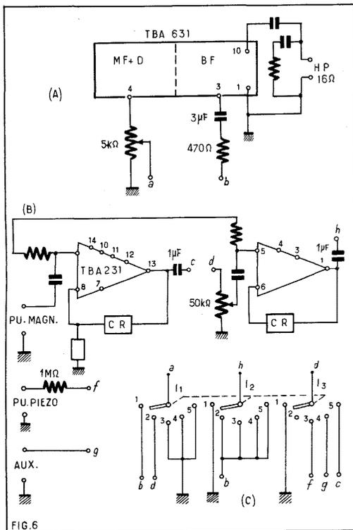
L'entrée AUX permet le branchement de la sortie détectrice d'un radiorécepteur, d'un microphone et même, celle d'un tuner FM monophonique ou stéréo mais sans possibilité d'effectuer la stéréophonie. La stéréo peut toutefois être obtenue à l'aide de ce montage lorsqu'on lui adjoint un radiorécepteur AM - FM ou FM monophonique et un décodeur.
