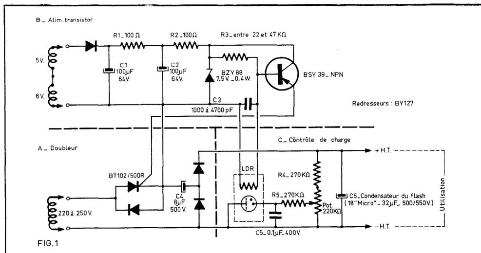
La haute tension est fournie par le secondaire 220 à 250 V d'un transformateur pour poste radio à lampes. Celle d'alimentation du transistor est délivrée par les secondaires de chauffage 5 V et 6 V branchés en série.
