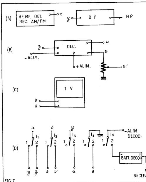
Un interrupteur sera disposé sur le décodeur pour couper l'alimentation en position 1. Comme on le montre sur la figure 7 (D), l'élément I<sub>5</sub> du commutateur peut effectuer la coupure de l'alimentation du décodeur en position 1.
