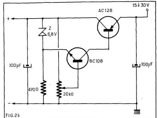
l'antenne comporte pour l'alimentation de ses circuits une tension régulée de 22 V.
