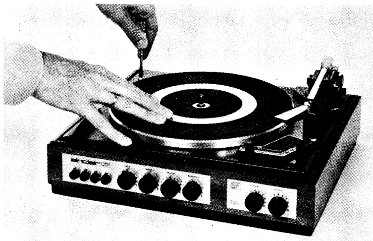
1. — L'ensemble platine-ampli assemblé. Remarquer, à droite, le filtre actif A.F.U.
