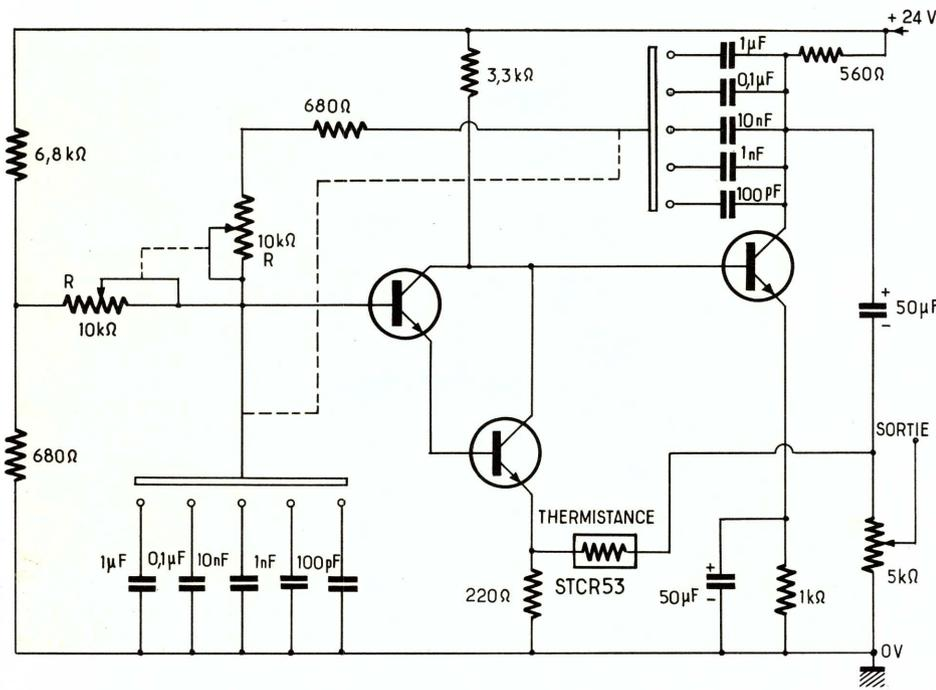
Les gammes de fréquences obtenues par commutation de différentes valeurs de condensateur sont les suivantes :
