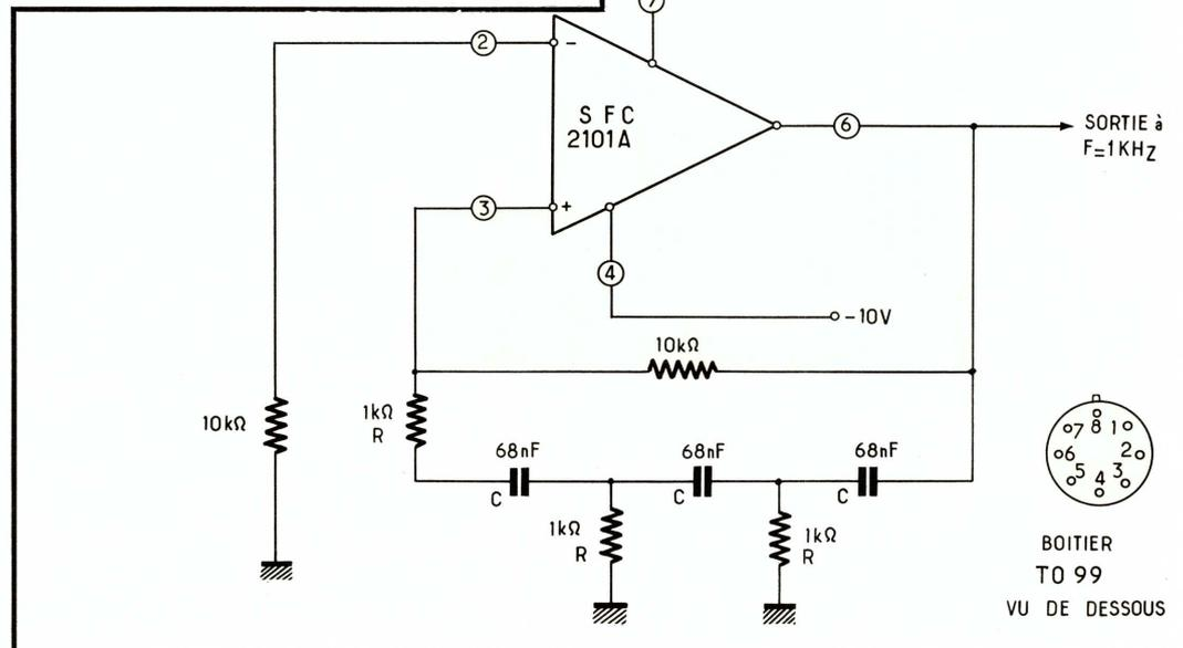
Ce montage utilise également un pont de Wien comme circuit déphaseur. Un circuit intégré est utilisé et le montage est proposé par Siemens. Le potentiomètre de 500 K $\Omega$  règle la symétrie du signal et celui de 10 K $\Omega$  le gain de l'ensemble. En fait ce réglage doit être fait en fonction de la distorsion du signal.
