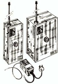
Émetteur EST/1. C'est le modèle de plus forte puissance, portée sol-air de plusieurs kilomètres. Puissance 850 mW à 2 W. Alimentation 12 ou 18 volts par pile ou accu. Piloté par quartz. Extension possible jusqu'en 8 canaux. Coffret métallique de 180 x 120 x 80 mm.
