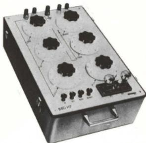
En raison de sa précision et de sa stabilité, le pont de Wheatstone type B 80 HP est particulièrement adapté aux mesures de haute précision : mesure ou comparaison de résistances étalons fixes ou variables et résistances servant de référence.
