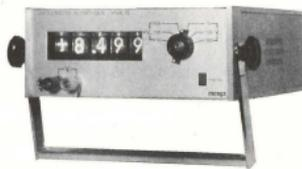
Cet appareil mesure les tensions continues de 1  $\mu$ V (résolution) à 1 000 V.
