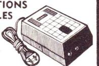
**STOLLE 3406**. Secteur 110 220 V. Sorties en courant continu stabilisé, commutable de 4-5-6-7, 5-9 et 12 V par transistor puissance et diode Zener. Débit 400 mA. Protection secteur (120x75x50). Livré avec câble secteur.
